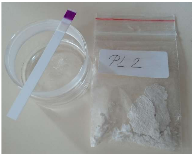
Obrázek 66: Kolorimetricky prokázáný výskyt dusičnanů z odebraného vzorky solných výkvětů
