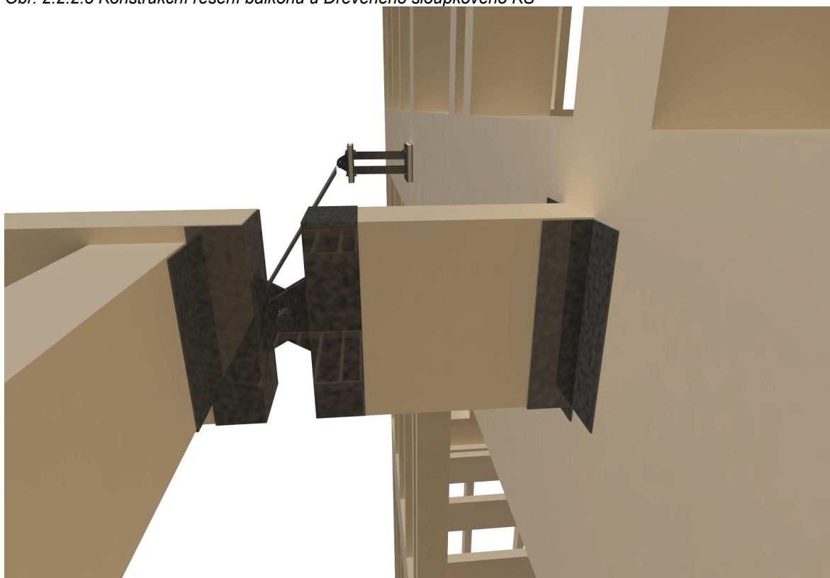
Obr. 2.2.2.6 Detail kotvení balkónu u Dřevěného sloupkového KS
