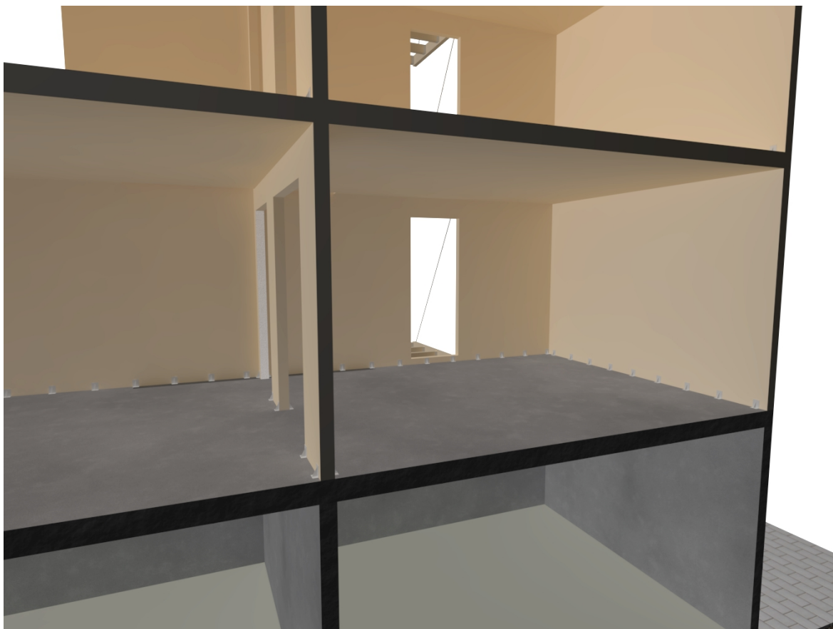
Obr. 2.2.4.2 Řez nosnou konstrukcí Dřevěného stěnového KS (CLT)
