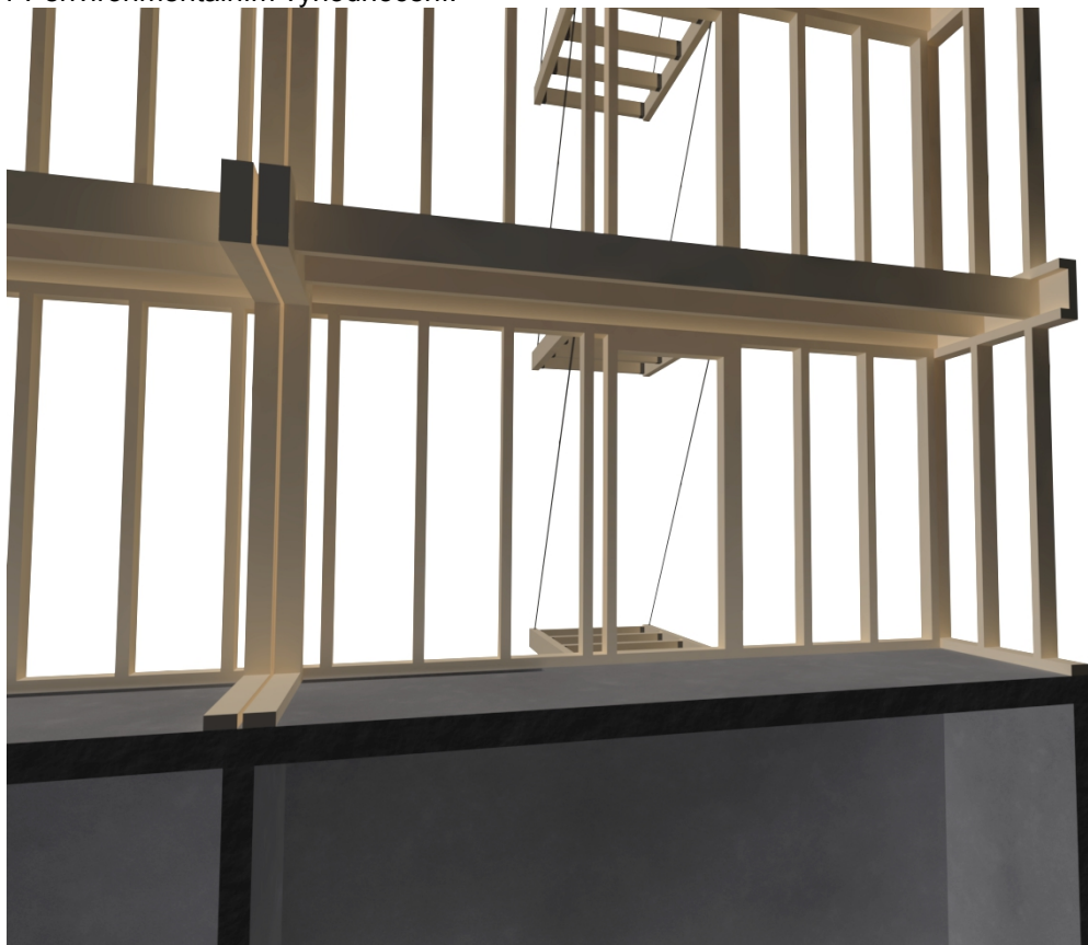
Obr. 2.2.2.2 Řez nosnou konstrukcí Dřevěného sloupkového KS
