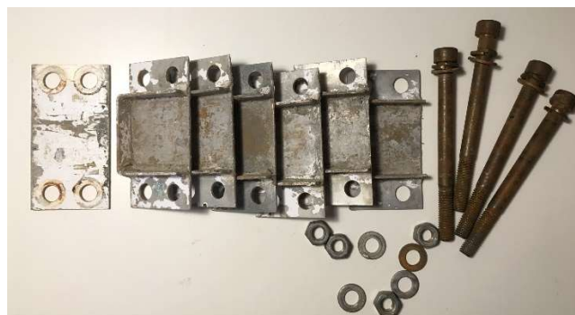
Obrázek 4-2- Rozebraná forma na betonové destičky
