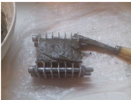
Obrázek 4-5 - Fotografie čerstvé betonové směsi ve formě
