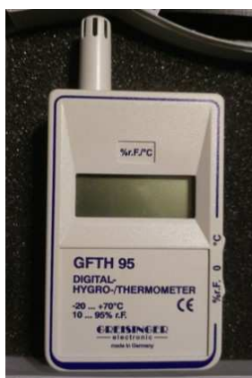
Obr. 42: Přístroj Greisinger GFTH 95
