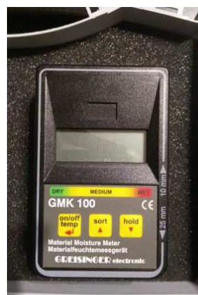
Obr. 43: Přístroj Greisinger GMK 100
