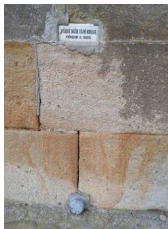
Obr. 5: Nivelační bod s informační destičkou
