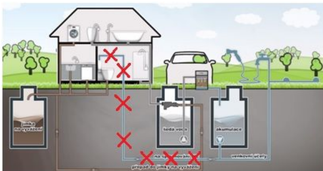
Obr. 9 - Rozvod šedé vody mimo objekt
