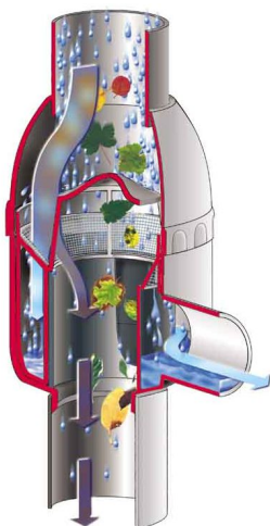
Obr. 2 - Svodové okapové filtry
