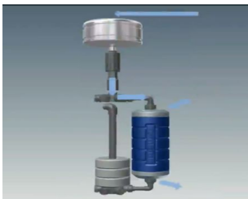
Obr. 19 – Čištění zpětným pracovním tokem
