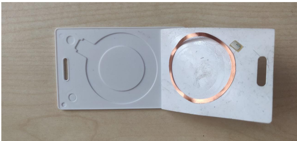
Obrázek 10 - Pasivní RFID tag složený z antény a integrovaného obvodu.
