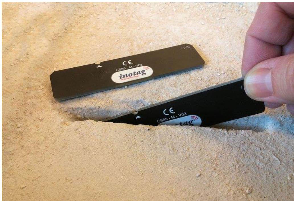
Obrázek 12 - RFID tag umístěný do podlahy. Převzato z: https://acsgroup.co.id/eng/products/rfid/rfid_tags/index.html
