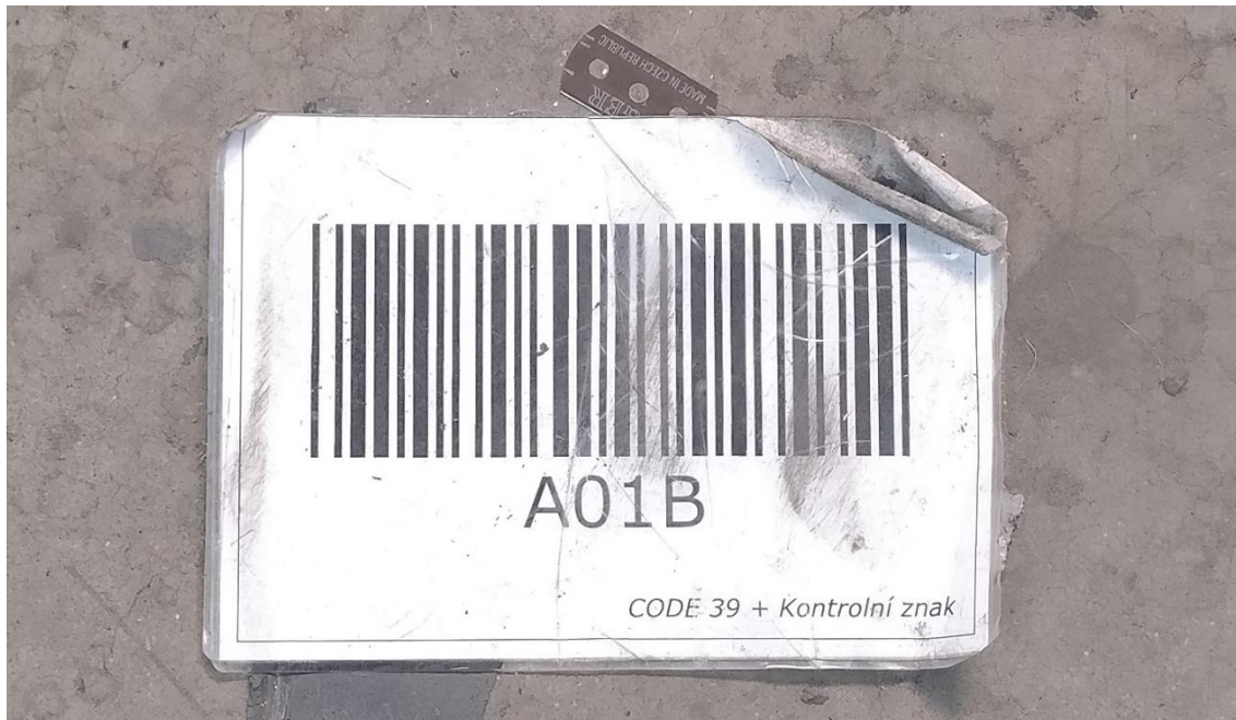
Obrázek 40 - Poškozený štítek na výstupu z linky izolačních skel.
