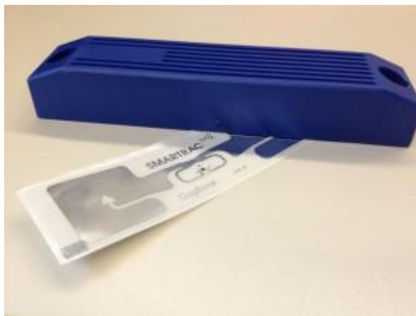
Obrázek 11 - Porovnání velikosti aktivního (modrý) a pasivního tagu. Převzato z: https://blog.atlasrfidstore.com/active-rfid-vs-passive-rfid
