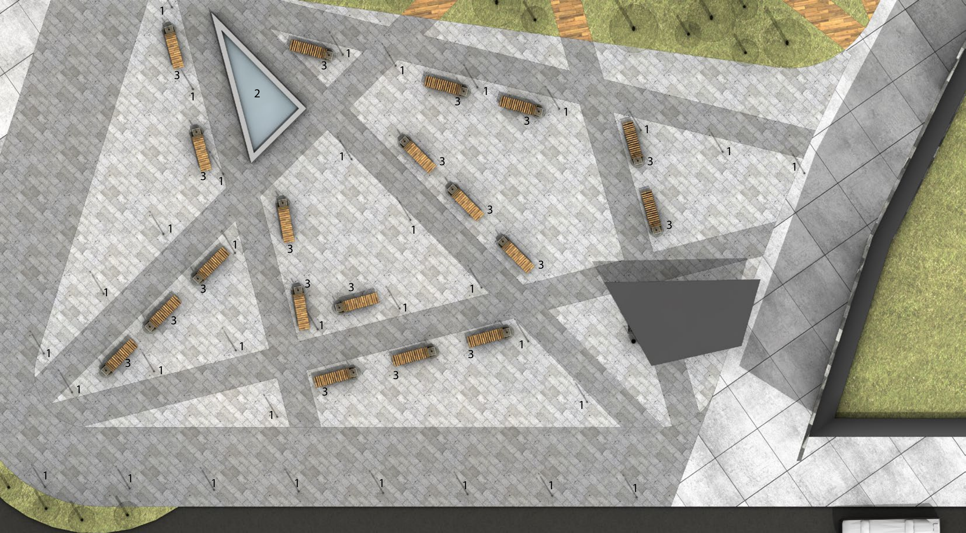
2. BETÓNOVÝ BAZÉNIK ZÁKLAD BETÓN POVRCHOVÁ ÚPRAVA BEZFARBÝ, VODEODLNÝ NÁTER SIKAGARD
