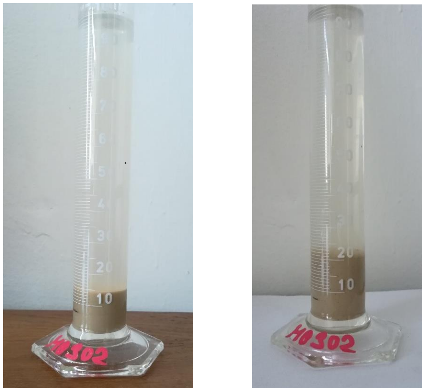
Obrázok 20: Odmerné valce po skúške merania Swell indexu. Vľavo vzorka z pece pri teplote 105°C, vpravo vzorka z pece pri teplote 206°C.
