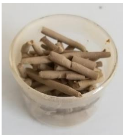
Obrázok 4: Valčeky pripravené do pece na zmeranie medze plasticity (laboratórium ČVUT).
