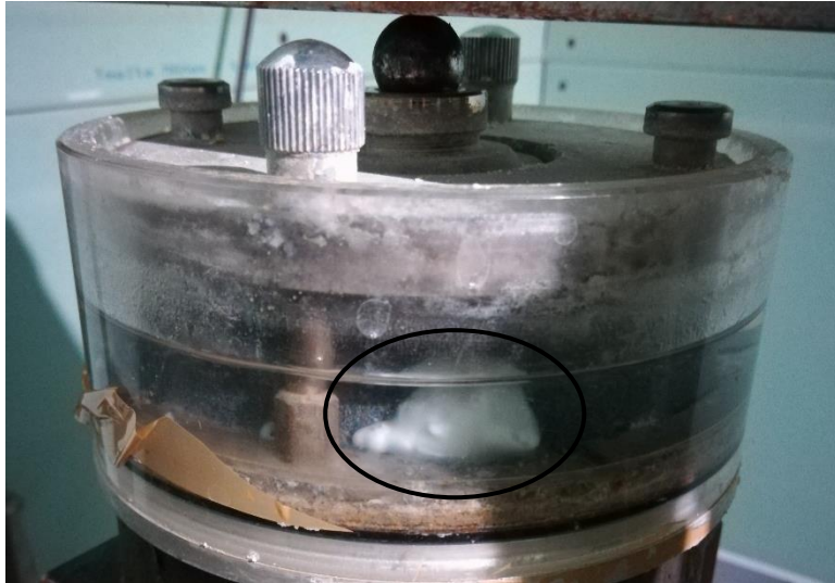
Obrázok 33: Suspenzia vytvorená v oedometrickej krabici OE103 počas testu
