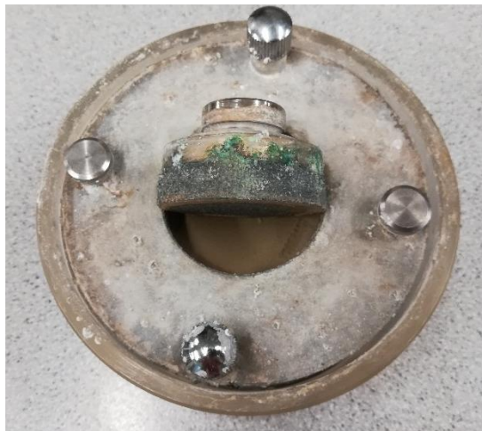
Obrázok 34: Rozobraná oedometrická krabica OE103 po ukončení skúšky –viditeľná korózia.
