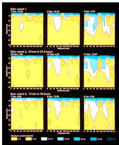
Obrázek 31: Preferenční proudění v homogenním materiálu (finger flow) (Ritsema et al. 1998)
