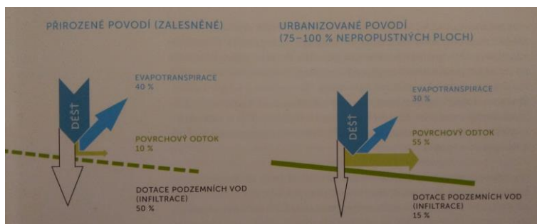
Obrázek 2: Porovnání odtoku přirozeného a urbanizovaného povodí (Vítek et al., 2015)
