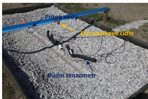
Obrázek 14: Dešťová zahrada s přítokem vody ze střechy
