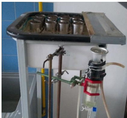
Obrázek 26: Pískový tank (vlevo), přetlakový aparát (vpravo)
