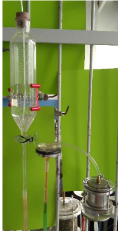
Obrázek 32: Měřicí sestava s konstantním hydraulickým spádem
