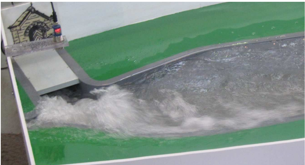
Obr. 14 - M17: Q_{max} – provzdušnění proudu na usměrňovacím žebro
