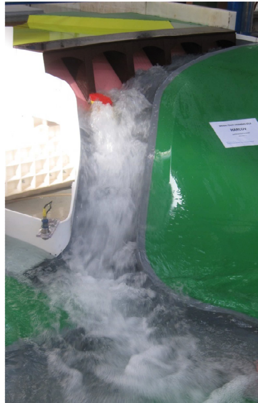
Obr. 9 - Porovnání skluzu s žebrem výšky 1 m (M10) a 1,5 m (M11) při průtoku Q_{20}
