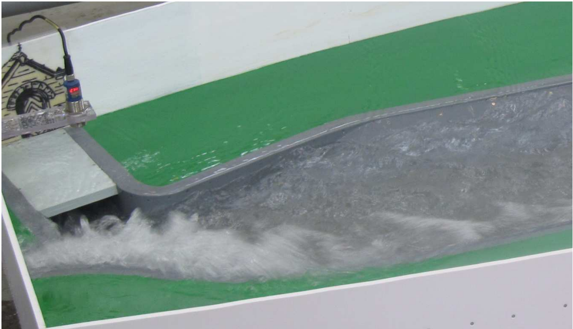
Obr. 13 - M13: Q_{max} – provzdušnění proudu bez usměrňovacího žebra
