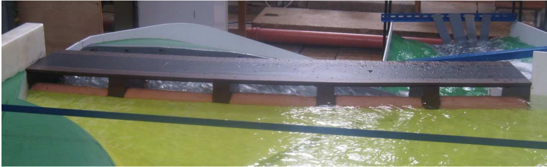
Obr. 5 - M3: bezpečnostní přeliv s odstraněnými klenbami na nátokové straně
