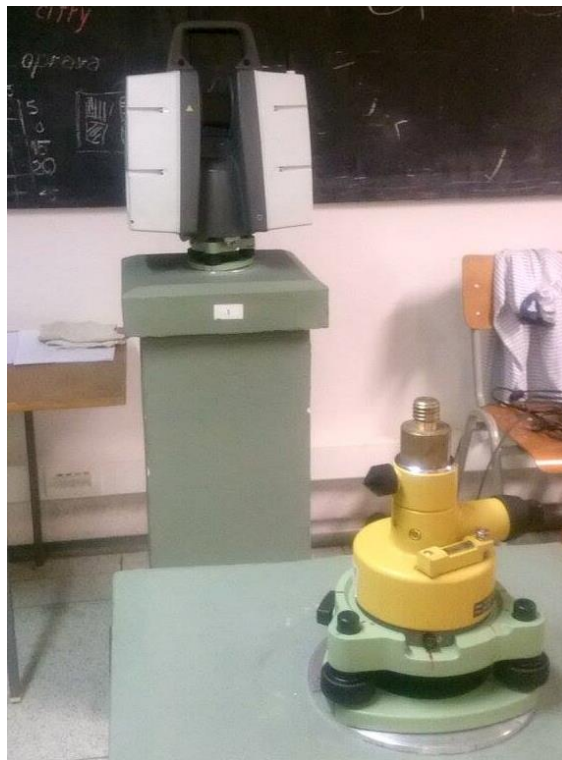
Obr. 20 Umístění trojnožky na pilíři délkové základny
