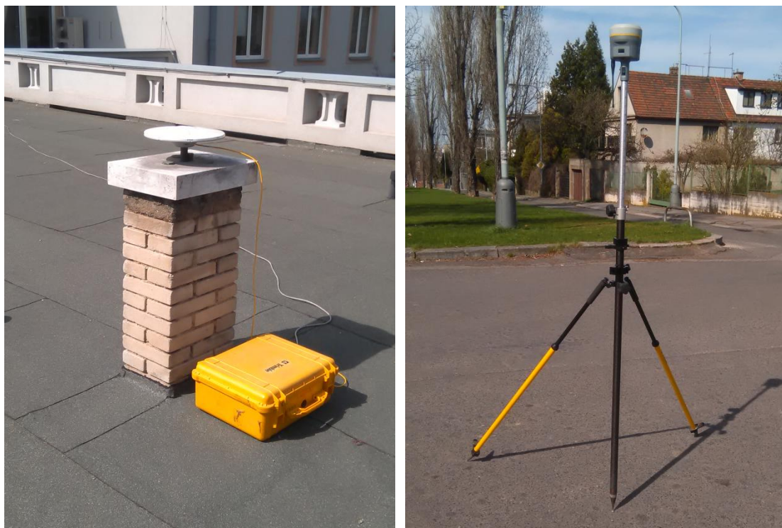
Obrázek 17: Pilíř na budově GFÚ s přijímačem Trimble R9s a anténou (vlevo), přijímač Trimble R10 při měření RTK na bodě (vpravo)
