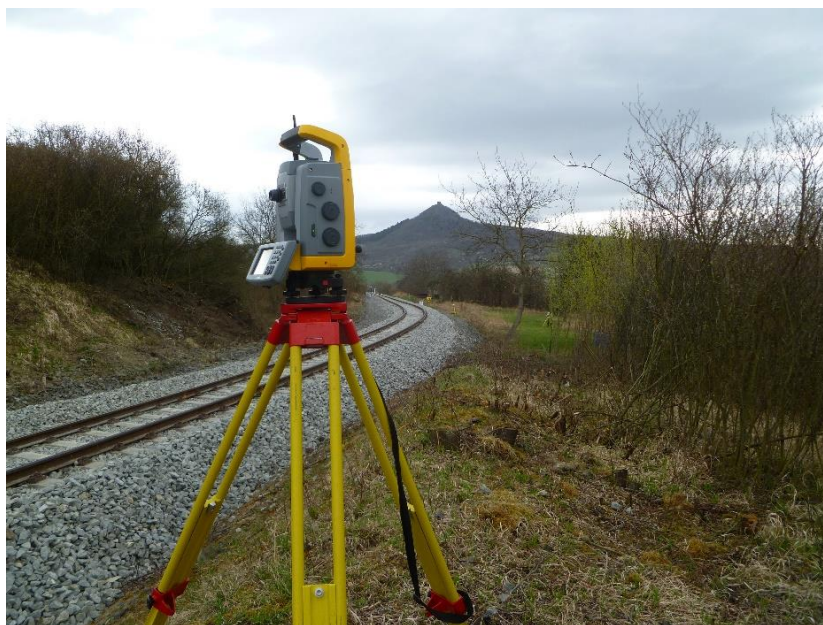
Obr. 17: Totální stanice Trimble S6
