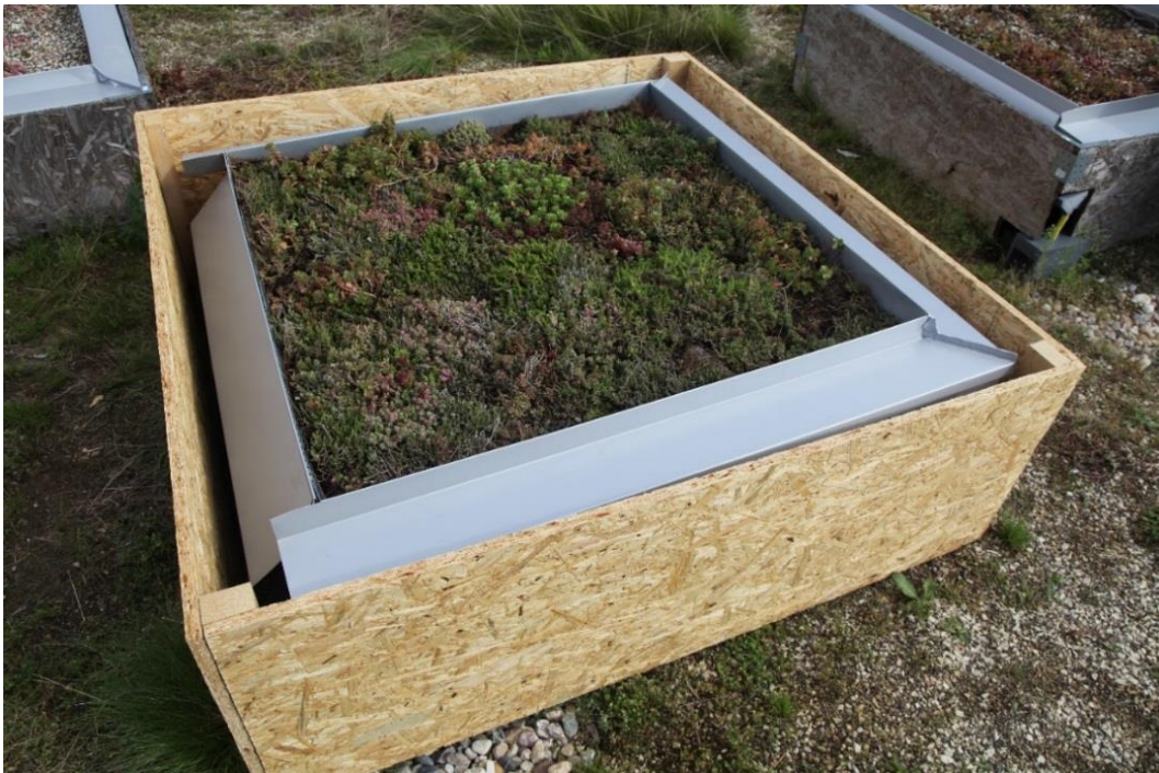
Obrázek 7: Opláštění segmentu OSB deskami
