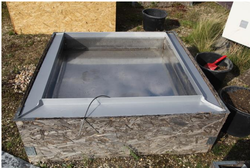
Obrázek 4: Holá konstrukce segmentu
