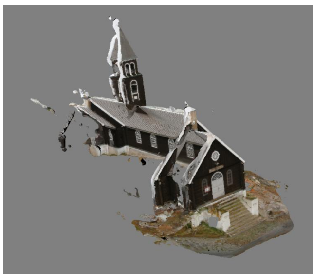
Obr. 6.24: Agisoft PhotoScan – 3D model kostela v Ilulissat (nezdařená strana) [vlastní tvorba]
