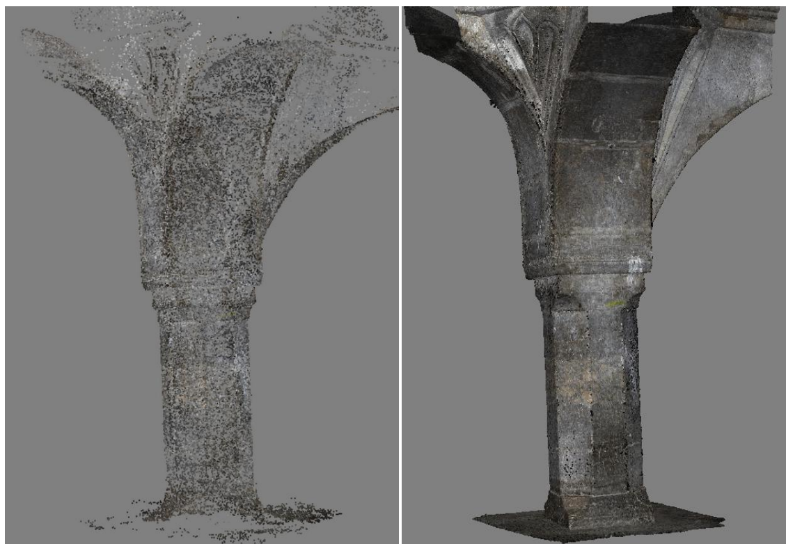
Obr. 6.11: Agisoft PhotoScan – Bodová mračna (vpravo) řídké a (vlevo) husté [vlastní tvorba]
