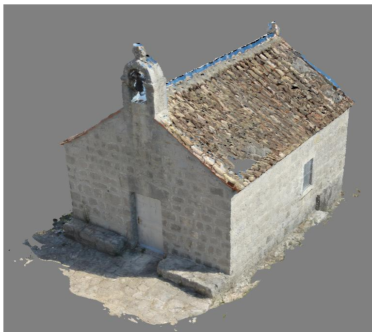
Obr. 6.28: Agisoft PhotoScan – 3D model kostela sv. Marco (špatné vykreslení střechy) [vlastní tvorba]
