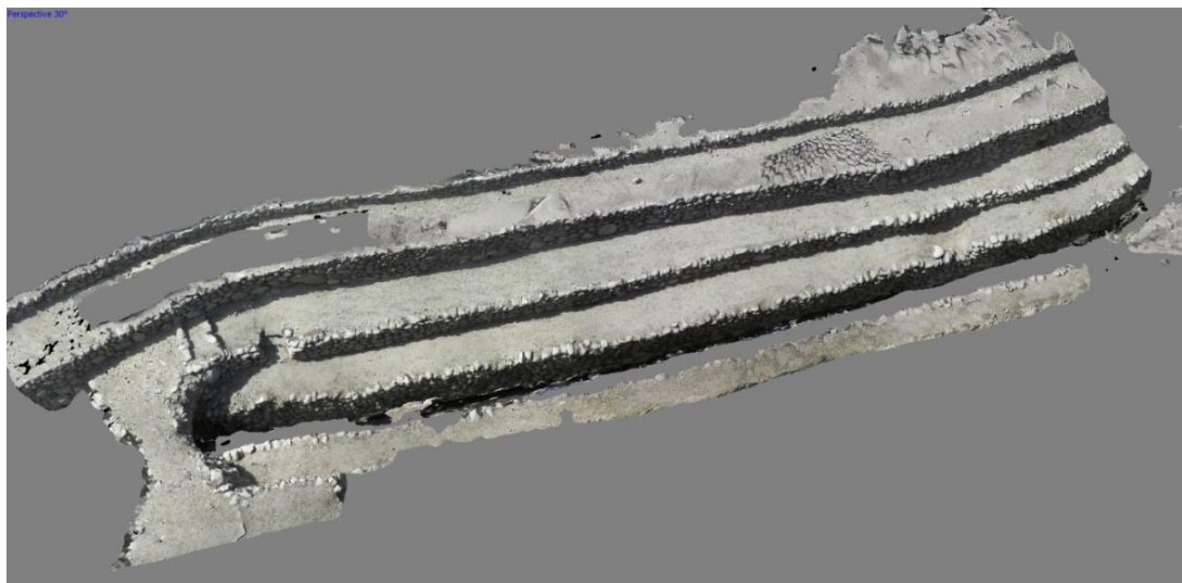
Obr. 6.7: Agisoft PhotoScan – 3D model akvaduktu [vlastní tvorba]
