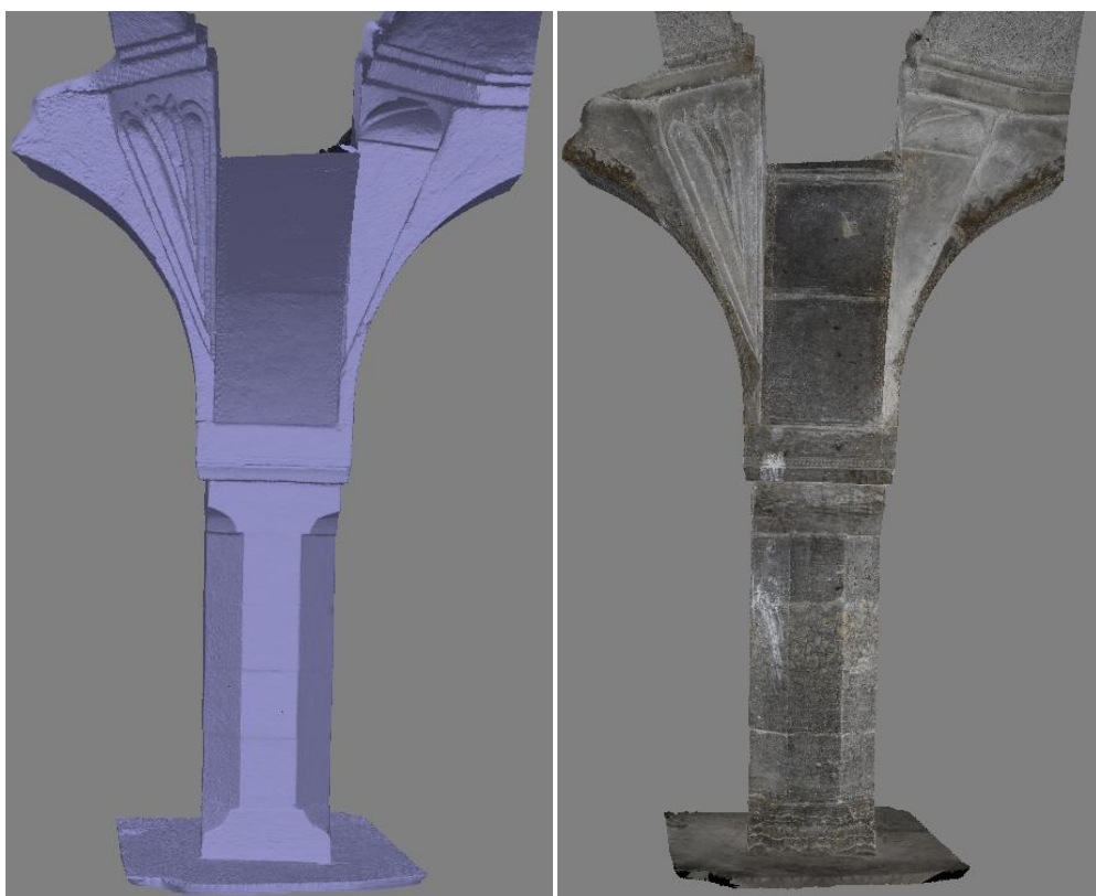
Obr. 6.12: Agisoft PhotoScan – polygonová síť (vpravo) a (vlevo) 3D model s texturou [vlastní tvorba]
