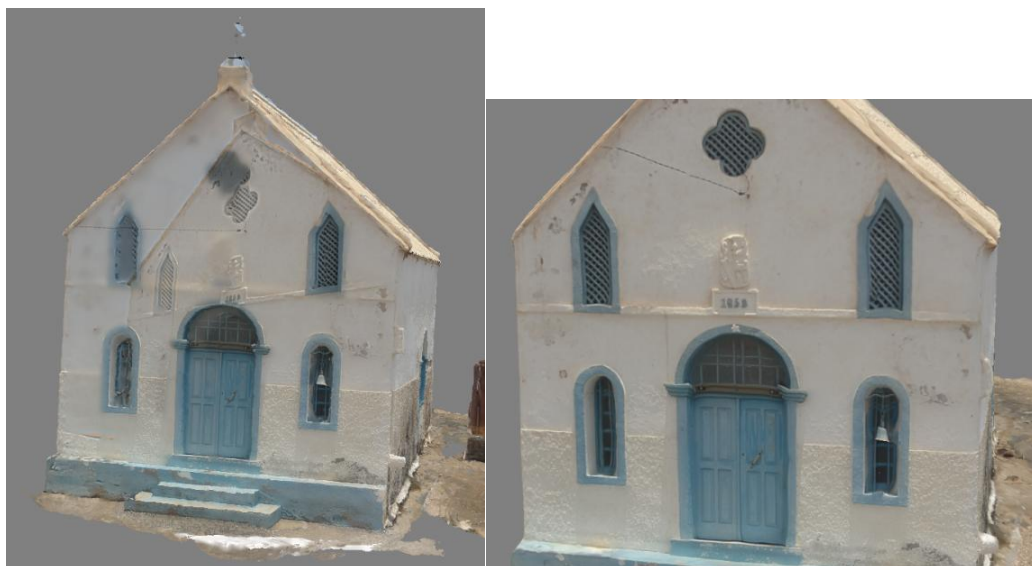
Obr. 6.26: Agisoft PhotoScan – 3D model kostela na ostrově Sal (chybná/správná textura) [vlastní tvorba]
