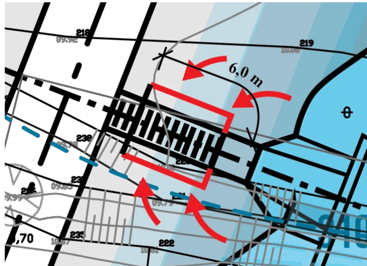
Obr. 7.6 Bezpečnostní přeliv jako sdružený objekt spodní výpusti
