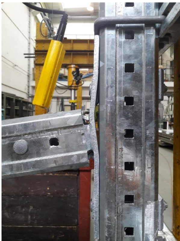
Obr. 27: Styčník před ukončením zkoušky
