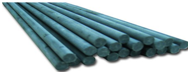
Obr.5 – uhlíkovo-vláknité tyče, zdroj:[14].
