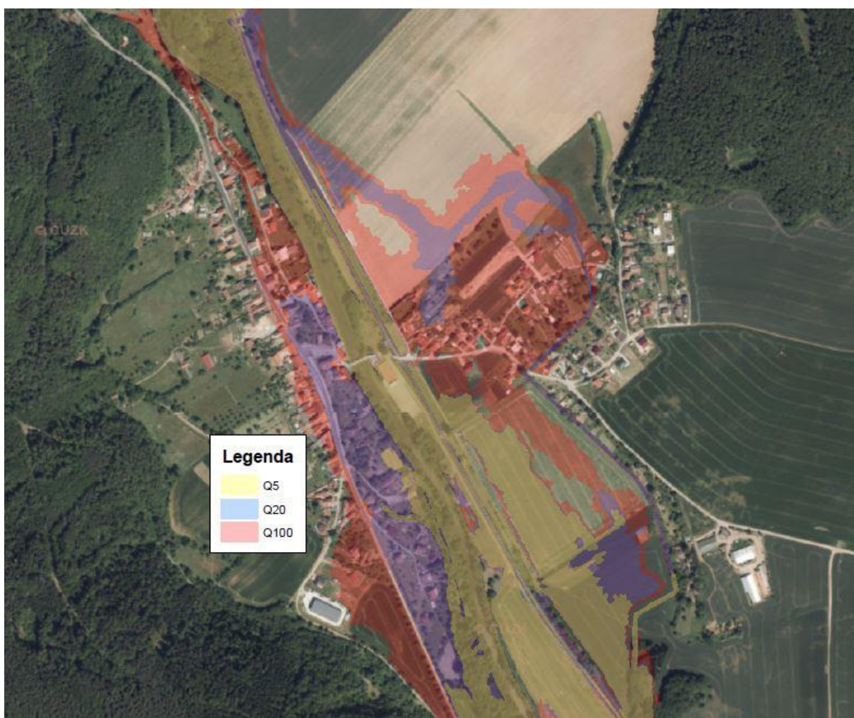
Obrázek 3-3: Plochy rozlivů Q_5 , Q_{20} a Q_{100} pro stávající stav v obci Štěpánovice
