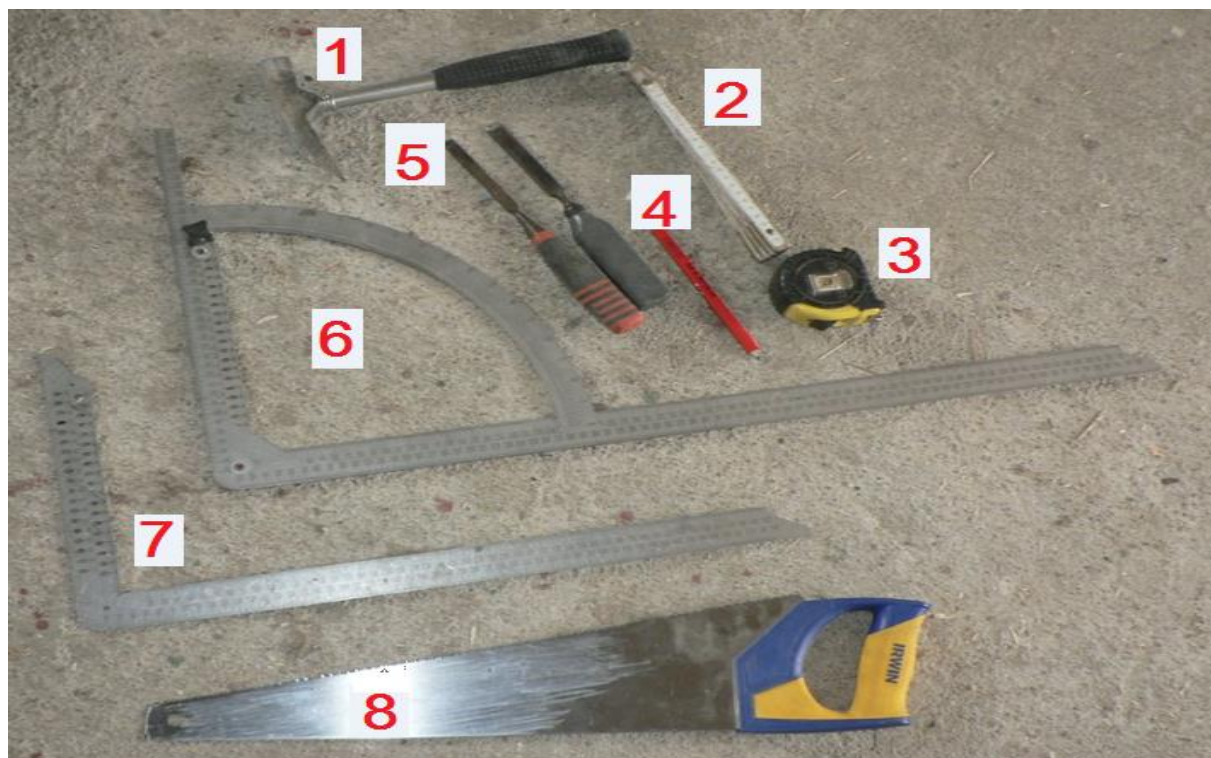
Obrázek 20 – Používané nástroje: 1 – tesařské kladivo, 2 – tesařský dřevěný metr, 3 – svinovací metr, 4 – tesařská hranatá tužka, 5 – dláta k dlabání, 6 – tesařský stupňový úhelník, 7 – tesařský pravoúhlý úhelník, 8 – ruční pila
