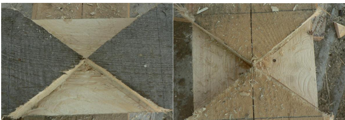
Obrázek 75 – Křížové kámpování: detaily prvků
