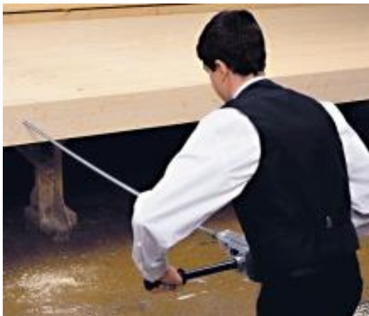
Obrázek 131 – Upevňování tyče WB-T
