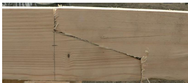
Obrázek 29 – Šikmý plát spojený
