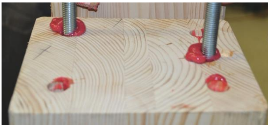
Obrázek 122 – Vlepované závitové tyče do dřeva
