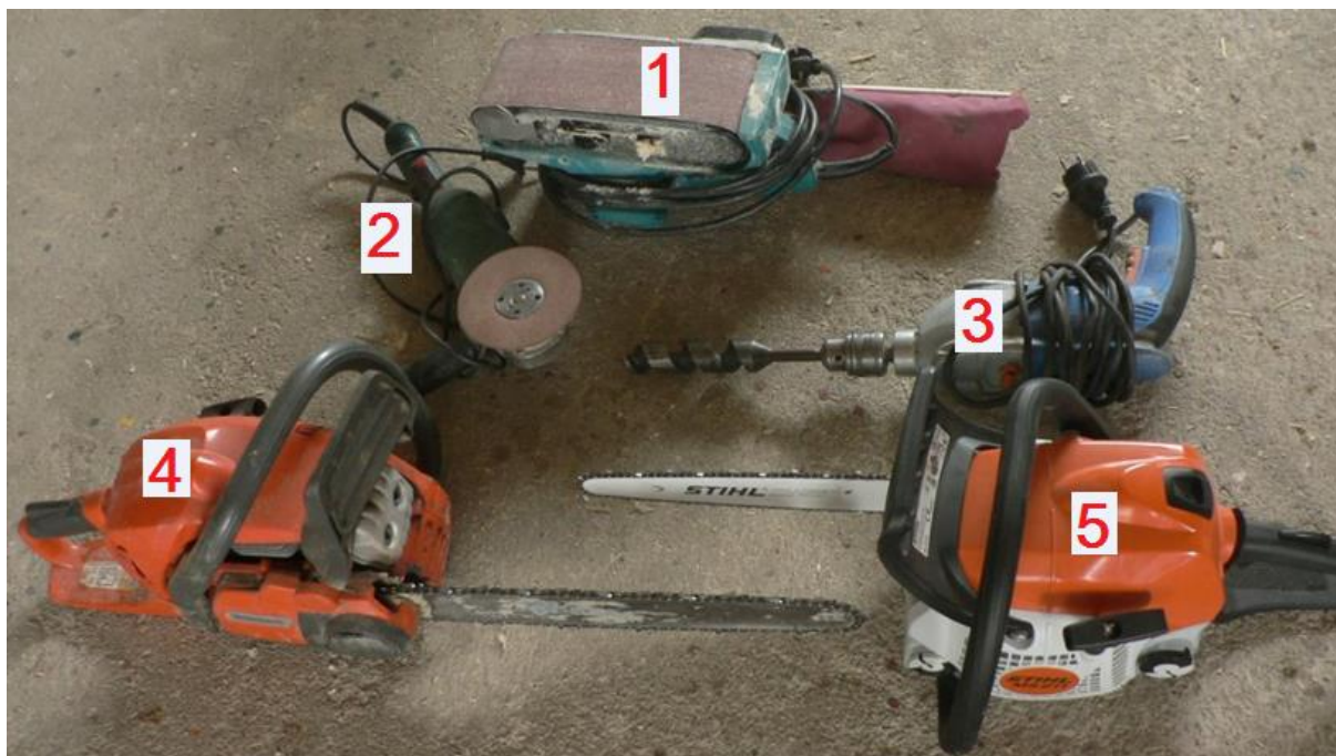
Obrázek 21 – Používané nářadí: 1 – elektrická pásová bruska, 2 – elektrická úhlová bruska s fibrovým kotoučem, 3 - elektrická vrtačka s vrtákem průměru 32 mm ke dlabání, 4 – motorová pila, 5 – motorová pila se speciální řezbářskou lištou a řetězem
