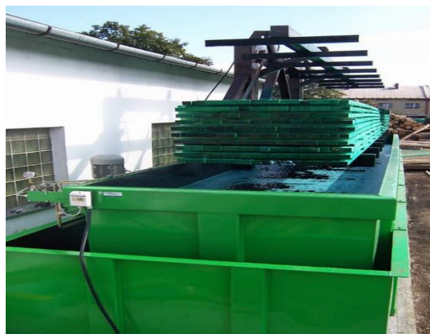
Obrázek 19 – Impregnace ponořením dřeva do vany
