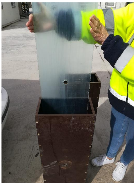
26 Deska z plexiskla vkládaná do bednění [Ondřej Boroš]
