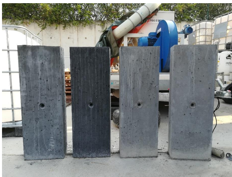
27 Referenční vzorky probarveného betonu čerstvě po odbednění (zleva - 5% S2, 5% S4, 6% S4, 4% S2) [Ondřej Boroš]
