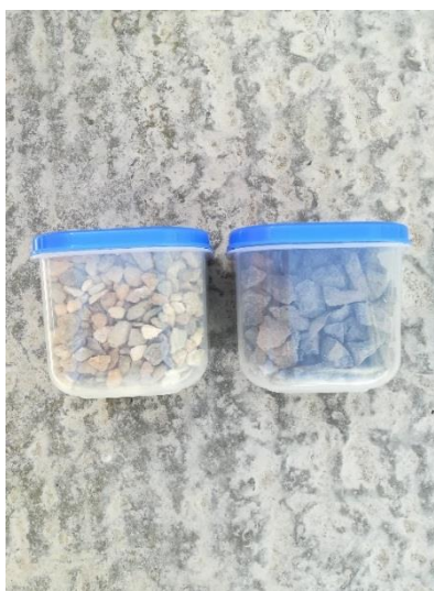
23 Kamenivo použité při výrobě probarveného betonu [Ondřej Boroš]
