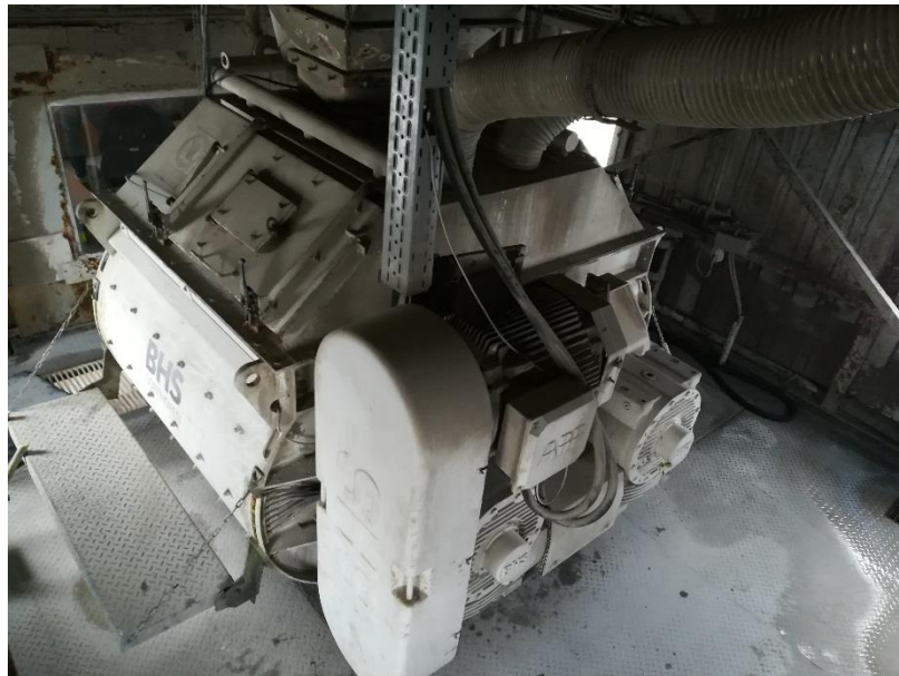
14 Dvouhřídelové mísící jádro - TBG Metrostav Rohanský ostrov [Ondřej Boroš]
