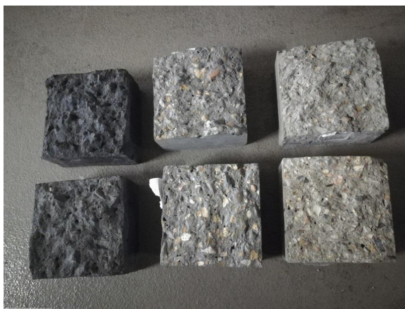
29 Vzorky po rozlomení (zleva horní - 5% S4, 4% S2, 0% S4 zleva dolní - 5% S2, 6% S4, 2% S4) [Ondřej Boroš]
