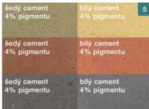
4 Rozdíl v použití šedého a bílého cementu [ www.betonks.cz ]
