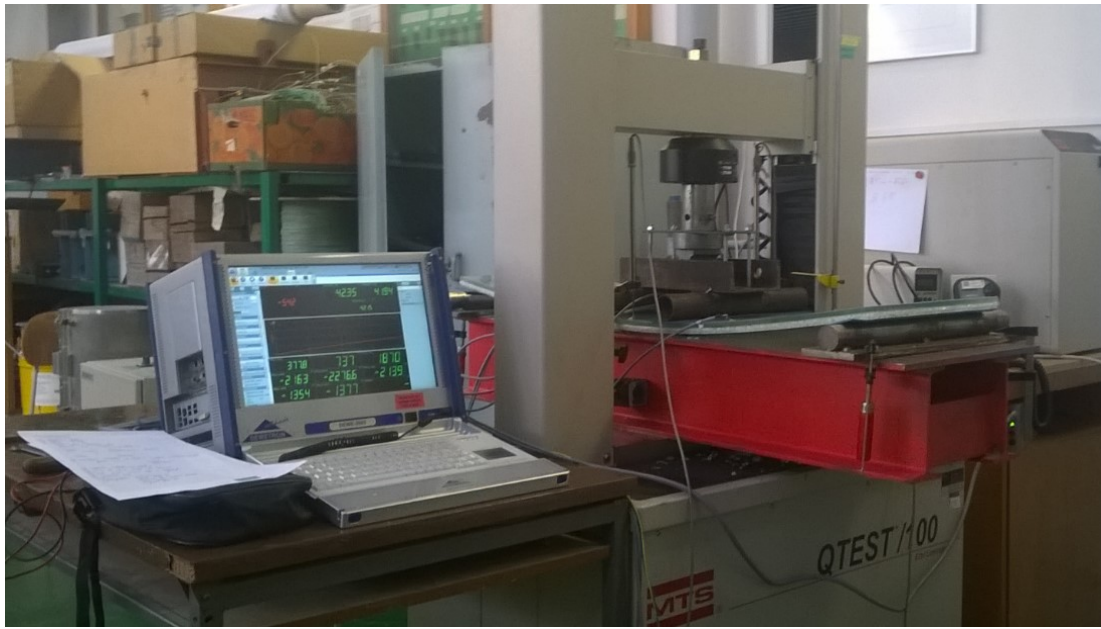
Obr. 4.9: Zkušební zařízení MTS-Q, ústředna, počítač
