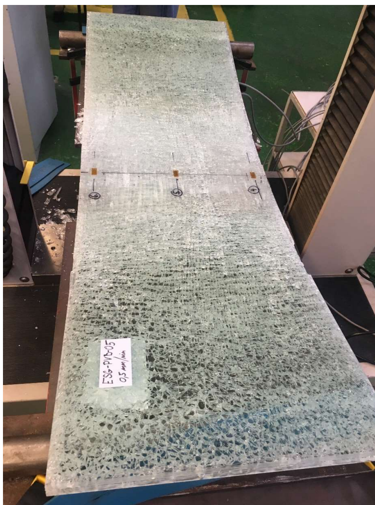
Obr. 4.10: Zkušební těleso po porušení celého souvrství
