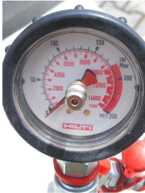
Obrázek 55 Naměřená maximální únosnost v tahu při nedodržení min. okrajových vzdáleností u úderové kotvy HKD M10x30
