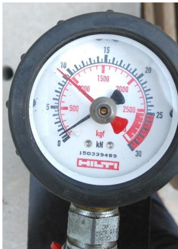
Obrázek 57 Naměřená maximální únosnost v tahu při nedodržení min. okrajových vzdáleností u kotevního šroubu HUS3-H M10x95
