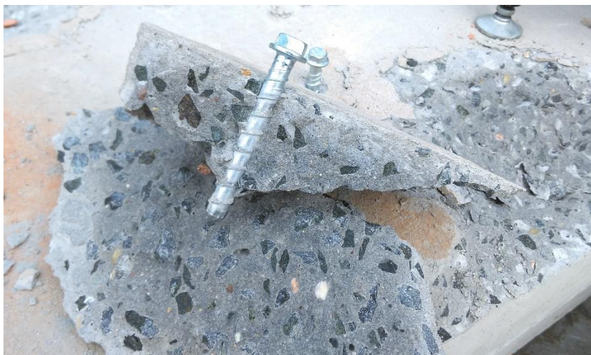
Obrázek 58 Upevňovací kotevní šroub HUS3-H s vytrženým betonovým kuželem
