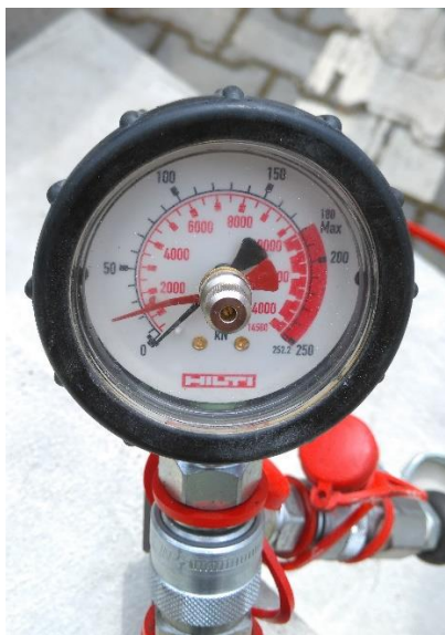
Obrázek 46 Tlakoměr s maximální dosaženou silou při porušení spoje
