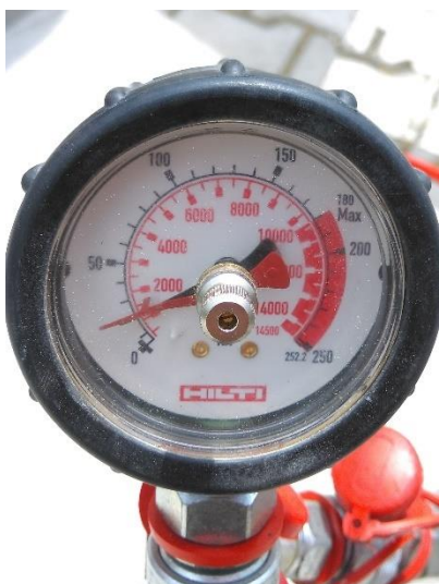
Obrázek 61 Naměřená maximální únosnost v tahu při nedodržení minimálních vzdáleností a nevyčištění kotevního otvoru
