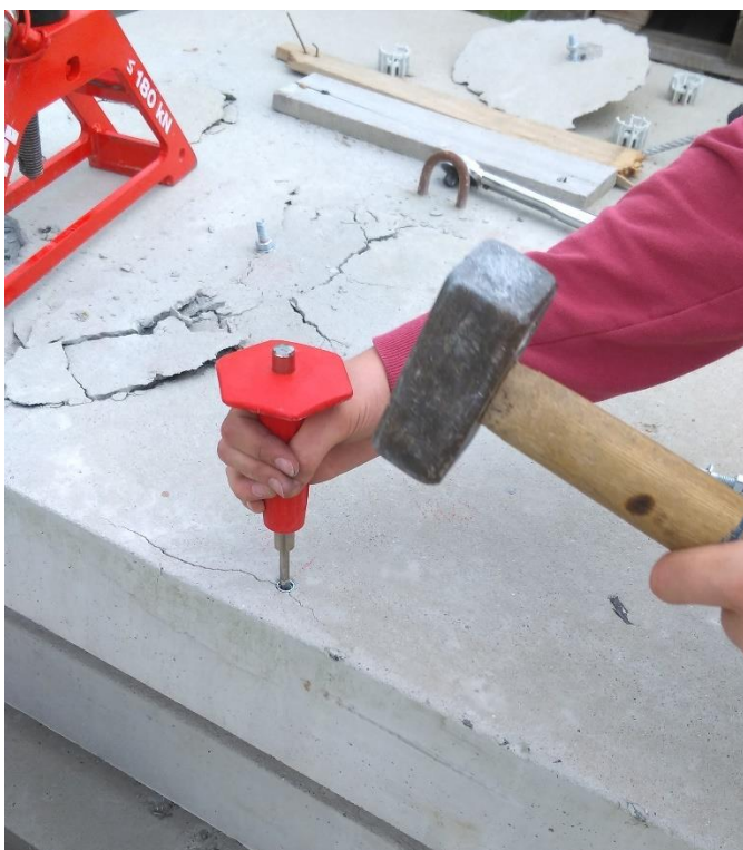
Obrázek 38 Vznik prasklin při aktivaci kotvy
