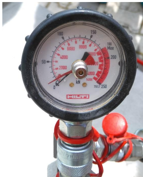
Obrázek 53 Naměřená maximální únosnost v tahu při nedodržení min. okrajových vzdáleností u expanzní kotvy HST3 M10x100
