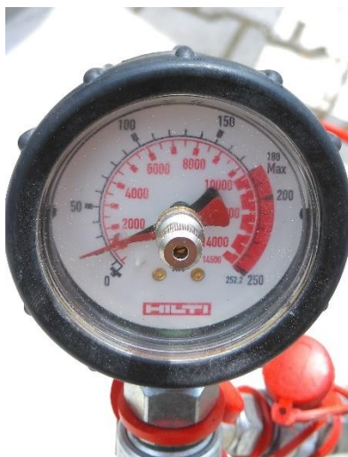
Obrázek 59 Tlakoměr s maximální tahovou únosností kotvy HST3 M10x100
