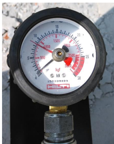
Obrázek 67 Naměřená maximální únosnost v tahu při nedodržení kotevní hloubky upevňovacího kotevního šroubu HUS3-H
