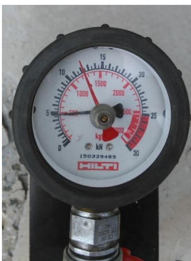
Obrázek 51 Tlakoměr s dosaženou maximální silou kolapsu kotevního spoje
