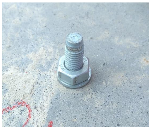
Obrázek 41 Přetažená expanzní kotva HST3 M10x100
