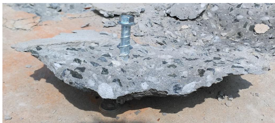
Obrázek 68 Upevňovací kotevní šroub HUS3-H s vytrženým betonovým kuželem
