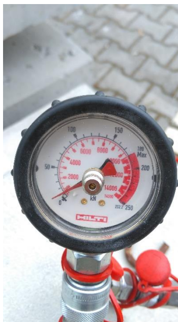
Obrázek 49 Tlakoměr s dosaženou maximální silou kolapsu kotevního spoje
