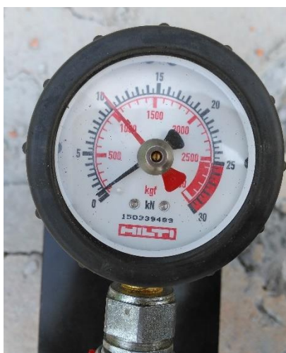
Obrázek 63 Naměřená maximální únosnost v tahu při nedodržení min. osových vzdáleností a nevyčištění kotevního otvoru u expanzní kotvy HST3 M10x100
