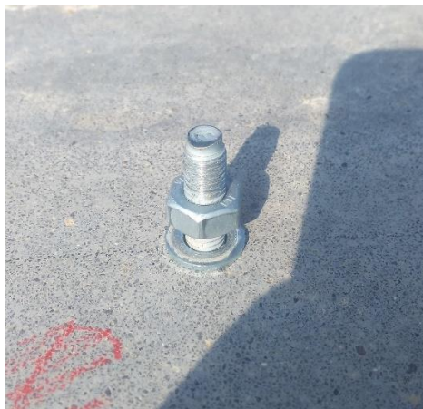
Obrázek 40 Neaktivovaná expanzní kotva HST3 M10x100
