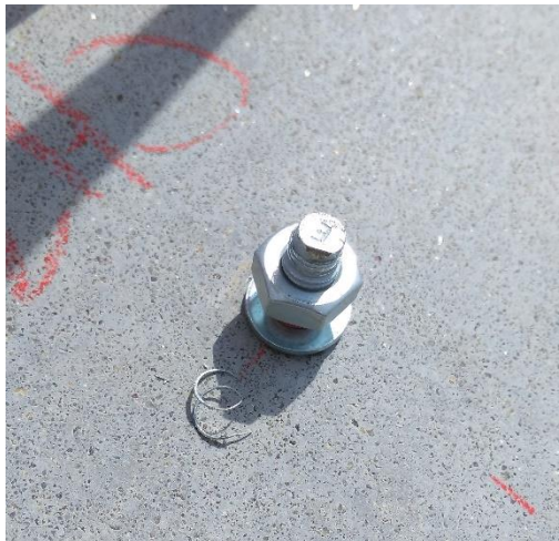
Obrázek 48 Vadná kotva HST3 s vytrženým závitem
