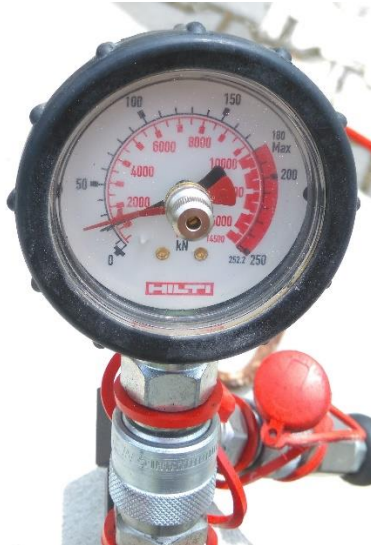
Obrázek 65 Naměřená maximální únosnost v tahu při nedodržení min. osových vzdáleností a nevyčištění kotevního otvoru u expanzní kotvy HST3 M10x100
