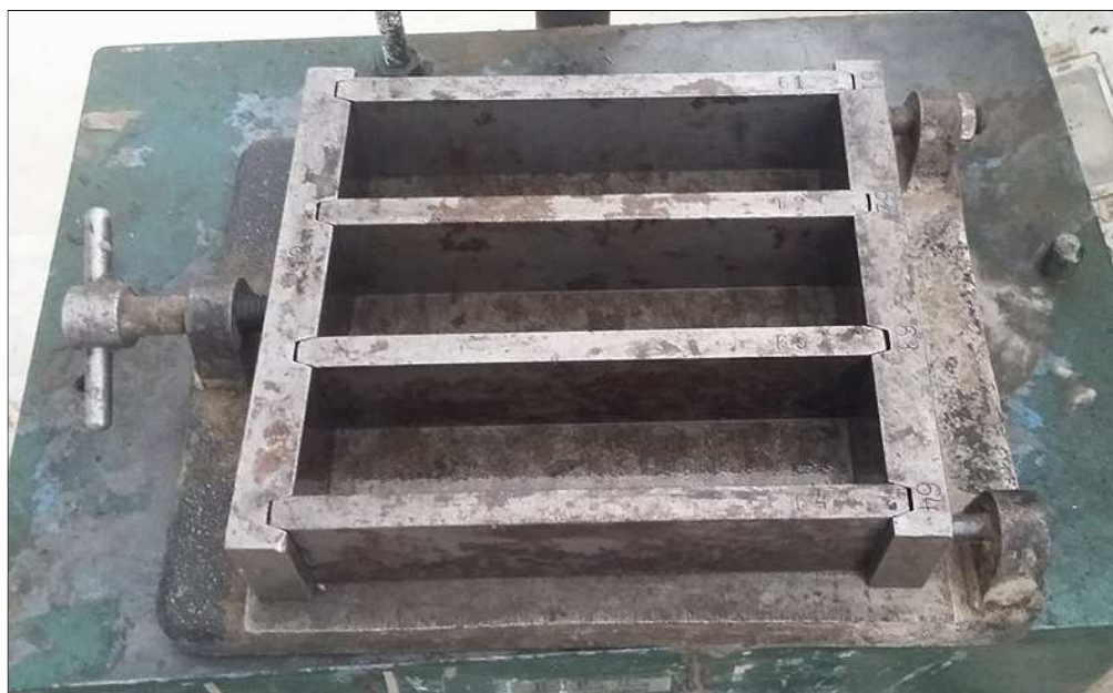
Obr. 9: Ocelová forma na výrobu zkušebních vzorků
