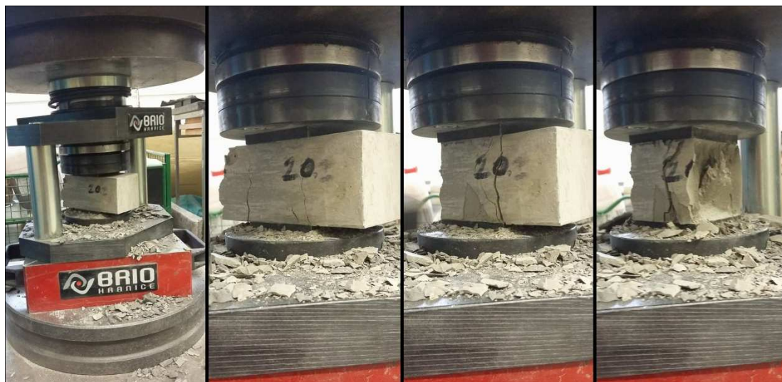
Obr. 15: Zkouška v prostém tlaku
