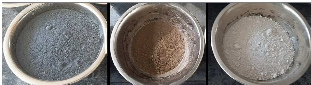
Obr. 8: Použité příměsi; a. - Křemičitý úlet, b. - Popílek, c. - Metakaolin
