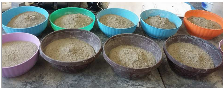
Obr. 10: Navážka cementu CEM I 42,5R
