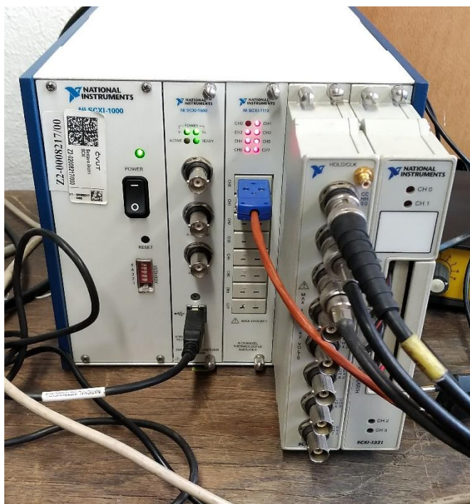
Obrázek 33 - National instruments SCXI 1000 v prostorách laboratoře Juliska
