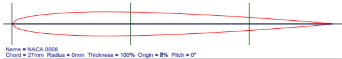
Obrázek 26 - Profil NACA 0008 Zdroj: [14]
