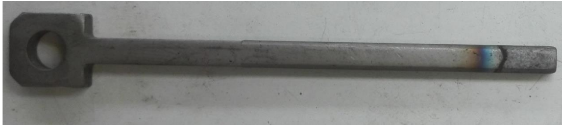
Obrázek 4. 13 Vzhled dílu po indukčním tepelném zpracování
