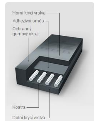
Obr. 3-29 Řez dopravním pásem s kostrou [19]
