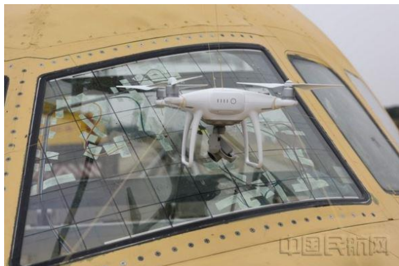
Obrázek 27: Fotografie z testu nárazu kvadrokoptéry do středu čelního skla kokpitu [45]
