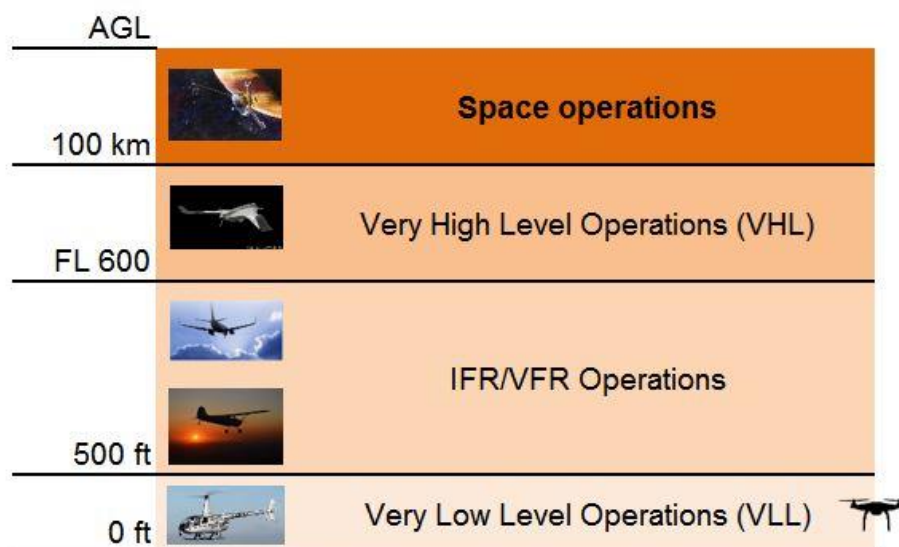
Obrázek 5: Rozdělení UA aktivit ve vzdušném prostoru, nová VLL vrstva (GND vrstva -500ft) [vlastní]
