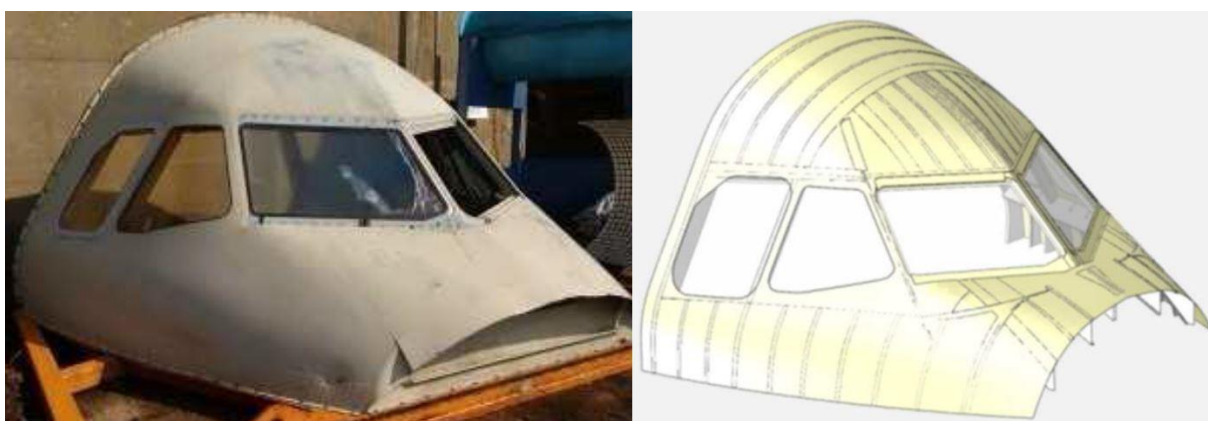
Obrázek 25: Kokpit pro testování poškození při simulovaném nárazu, vpravo počítačový model [24]
