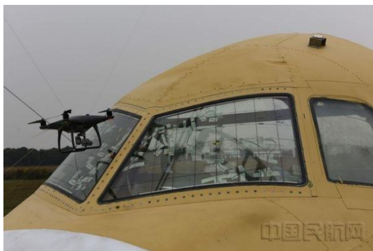
Obrázek 28: Fotografie z testu nárazu kvadrokoptéry do rohu čelního skla kokpitu [45]
