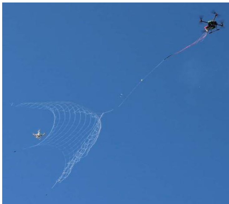
Obrázek 45: Odchyt potenciálně nebezpečného UA jiným dronem do sítě [52]
