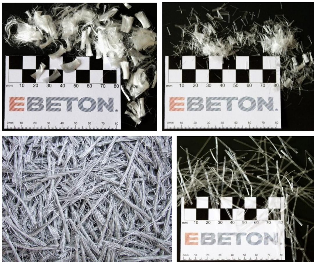
Obr. 19: Polymerová mikrovlákná (nahore) a makrovlákná (dole). [4]
