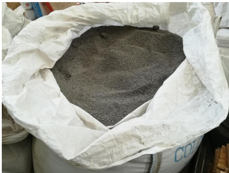
Obr. 31: Foto velkoobjemového vaku s použitým čedičem frakce 0/4mm.
