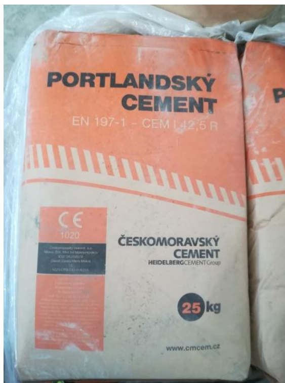
Obr. 30: Foto použitého typu cementu, portlandský cement CEM I 42,5 R.
