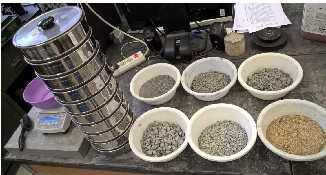
Obr. 35: Foto sady prosévacích sít s různými frakcemi kameniva při prosévací zkoušce.
