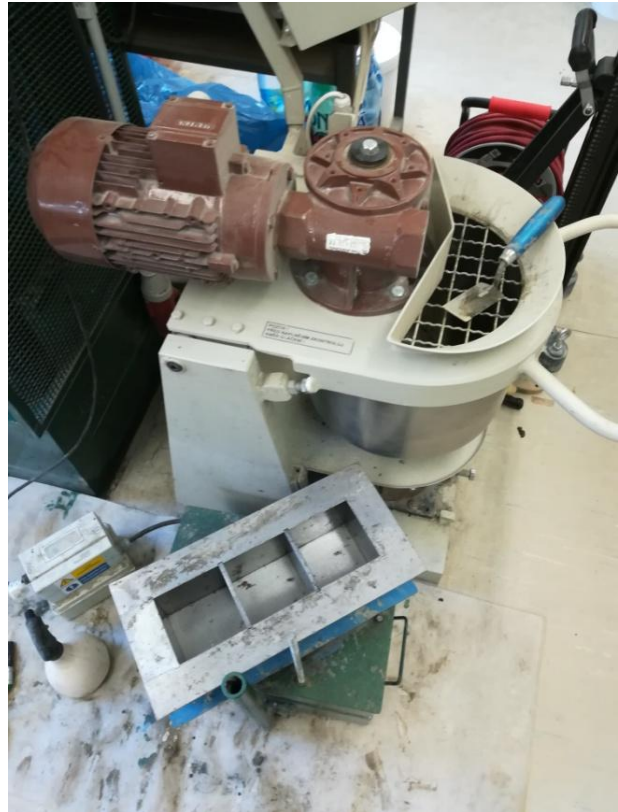
Obr. 36: Foto laboratorní míchačky betonu a prázdné bednicí formy na vibračním stolku.
