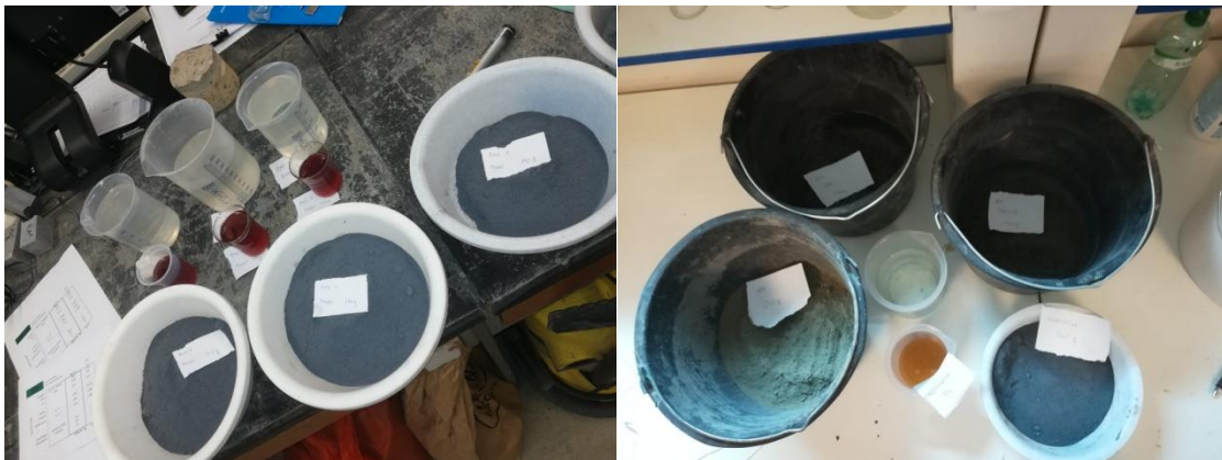
Obr. 44: Foto navážených složek HPC, připravených pro smíchání.
