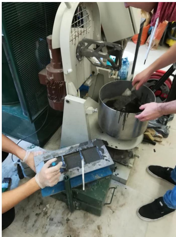
Obr. 45: Foto ukládání čerstvého betonu do bednicí formy.
