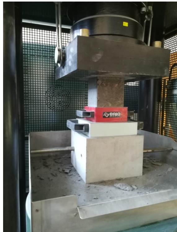
Obr. 37: Foto zkušebního (tlakového) lisu při zkoušce tlakové pevnosti betonu.
