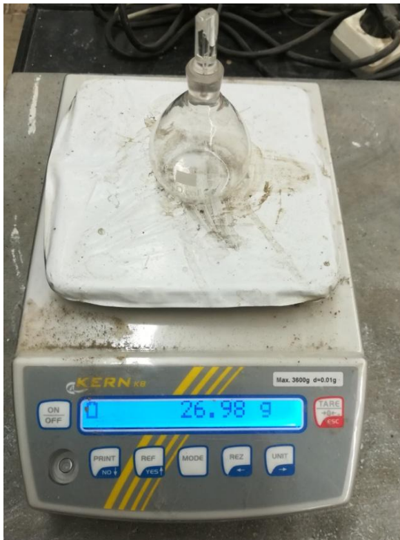
Obr. 34: Foto laboratorních vah s pyktometrem.
