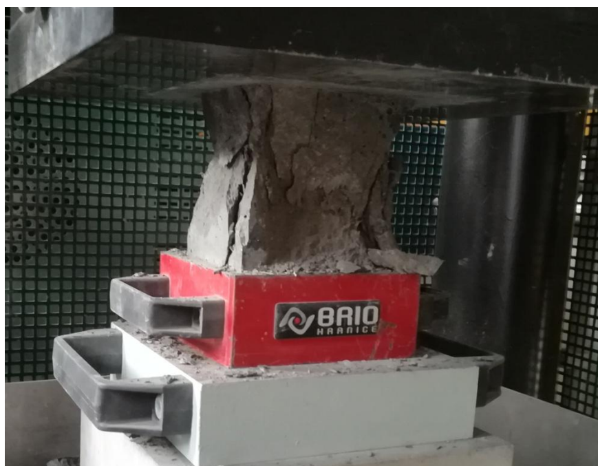
Obr. 49: Foto správného porušení zkušebního vzorku v lisu při tlakové zkoušce
