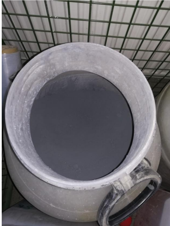
Obr. 33: Foto barelu naplněného použitou příměsí křemičitého úletu, STACHESIL S.
