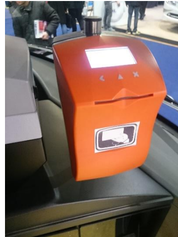
Obrázek 10: Telmax FCU 800 - terminál cestujícího s termotiskárnou (foto autor 2018) [6]
