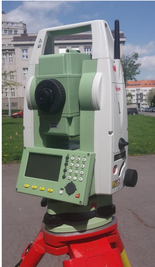
Obr. 3 Totální stanice Leica TS06
