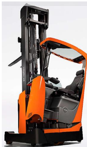
Obrázek 13. Retrak s naklopenou kabinou řidiče [zdroj: https://toyota-forklifts.cz ]
