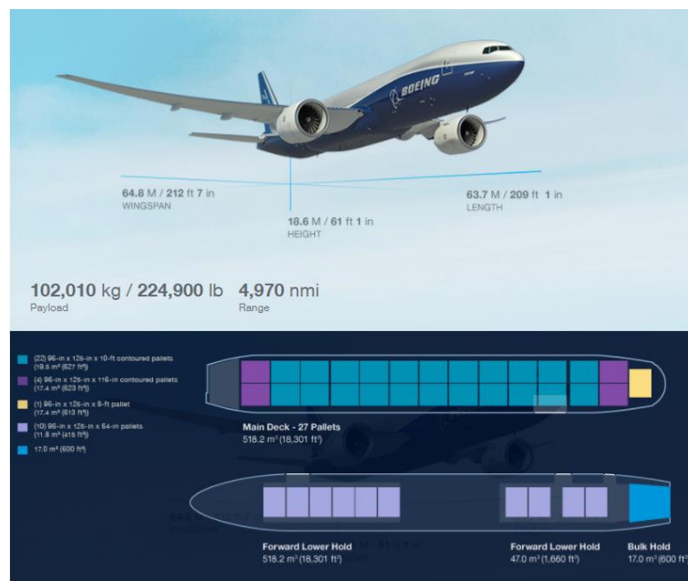
Obrázek 6. Boeing 777F a uspořádání nákladového prostoru [zdroj: http://www.boeing.com ]
