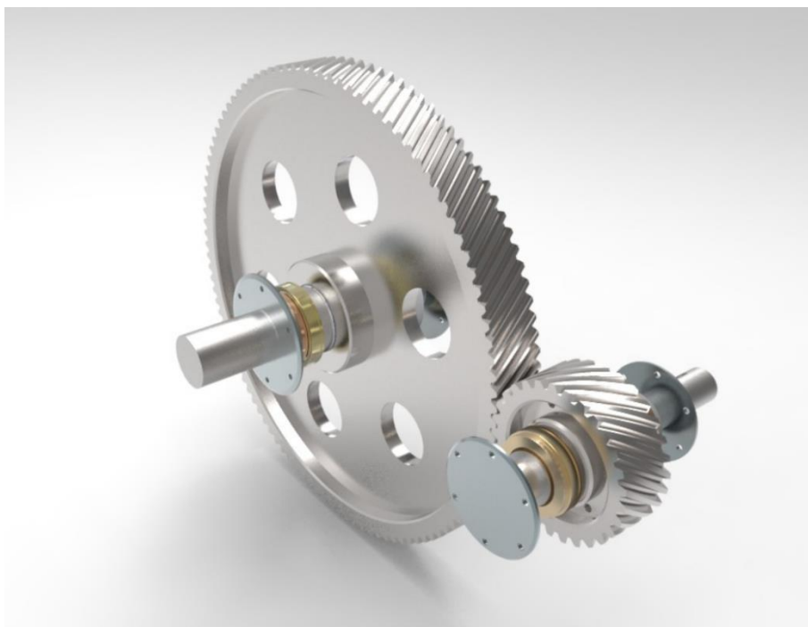
Obr. 3 - Jednostupňová dvojhriadeľová prevodovka [8]
