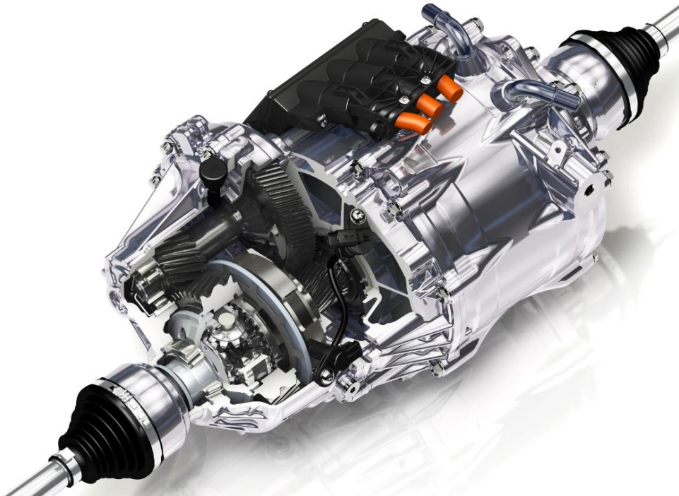
Obr. 5 - Koaxiálna trojhriadeľová prevodovka – BMW – i8 [10]
