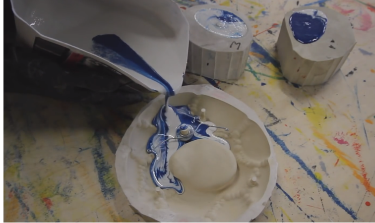
Obrázek 5.1. Proces odlívání chytu [36]
