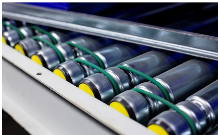
Obr. 16 Schéma spojení válečků pomocí řemínek [33]
