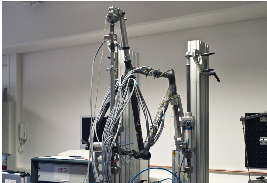
Obrázek 11: Zkušební rám při zkoušce svislou silou [8]
