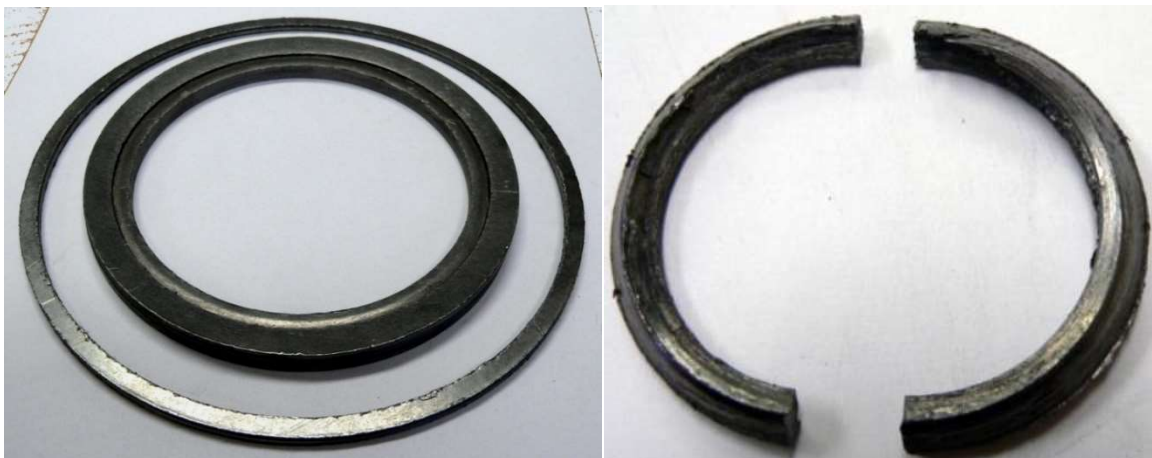
Obr. 1.5: Těsnící kroužky z expandovaného grafitu (vlevo) a dělené závitové kroužky (vpravo) [3]
