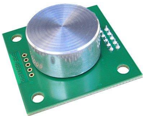
Obrázek 7 Ultrazvukový snímač SRF485WPR [9]
