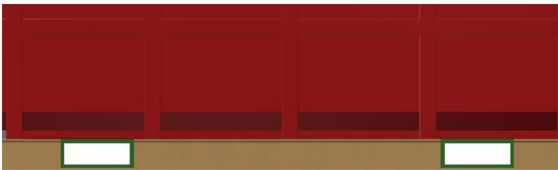
Obr. 24.: Umístění nabíracích otvorů do prostoru spodních ližin
