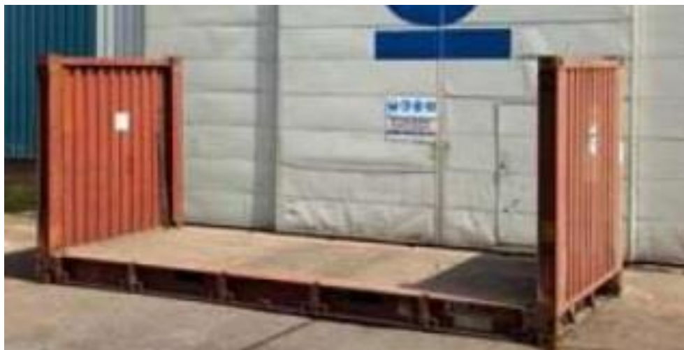
Obr. 5.: Plošinový kontejner se sklopnými čely [3]
