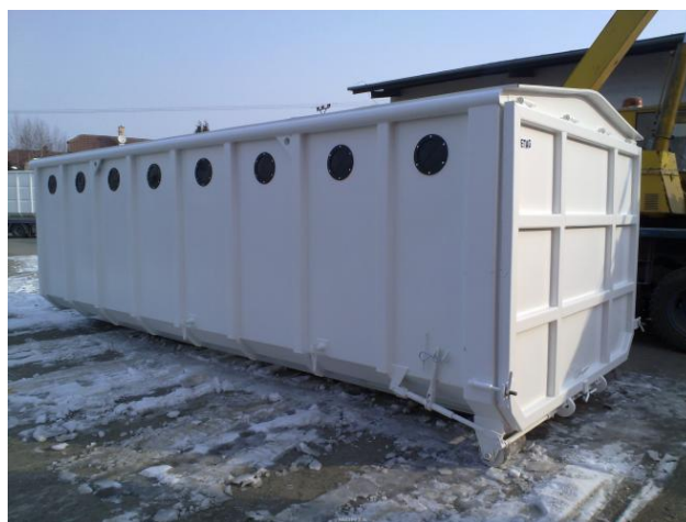
Obr. 8.: Kontejner na třídění odpad Abroll [5]
