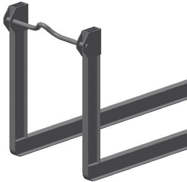
Obr. 19.: Závěs pro nákladní automobily s podélnými ližinami
