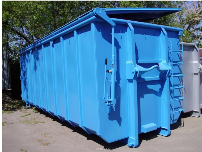
Obr. 7.: Uzavřený kontejner Abroll s odklápěcí střechou [5]
