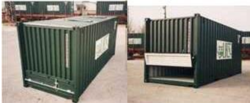
Obr. 4.: Kontejner pro suchý sypký náklad [4]
