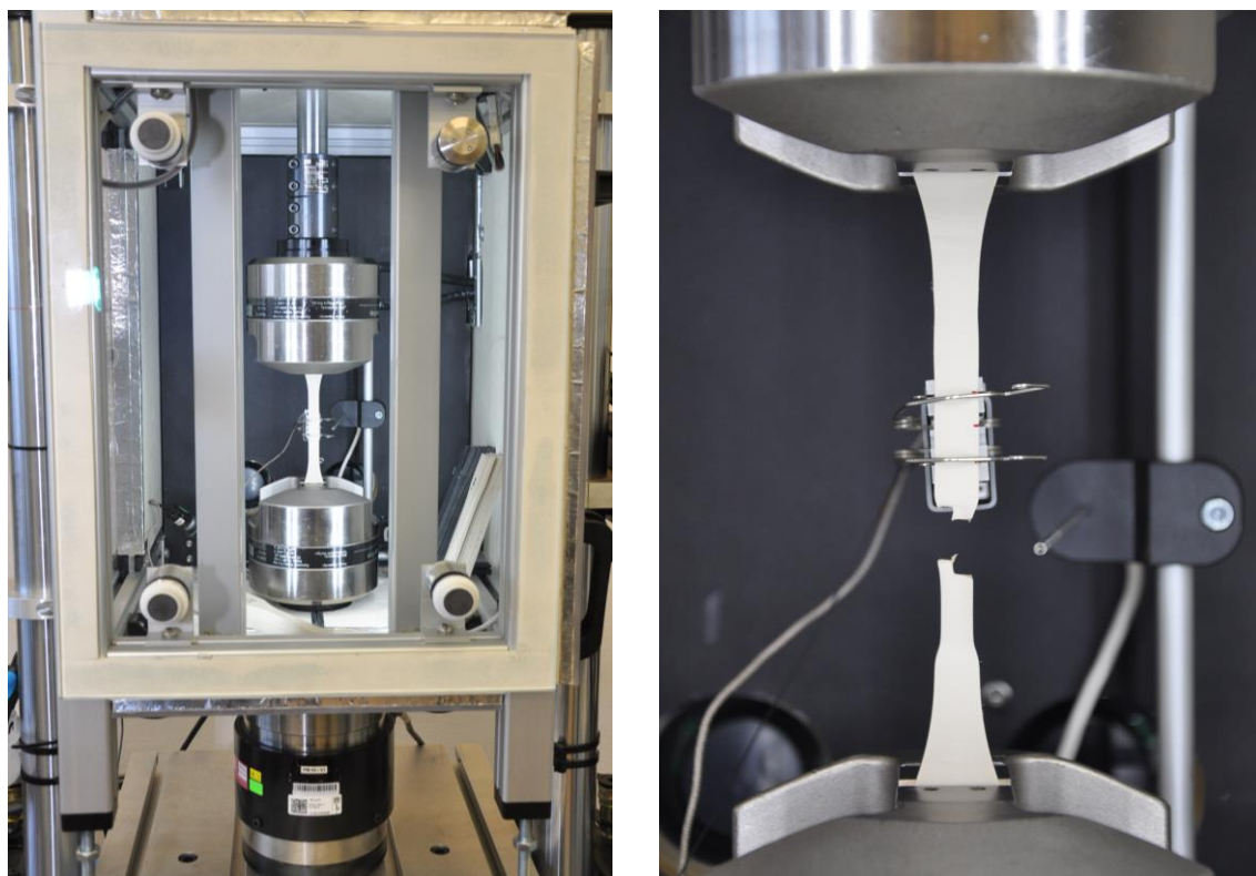
Obrázek 14 - Uspořádání experimentu a destrukce vzorku
