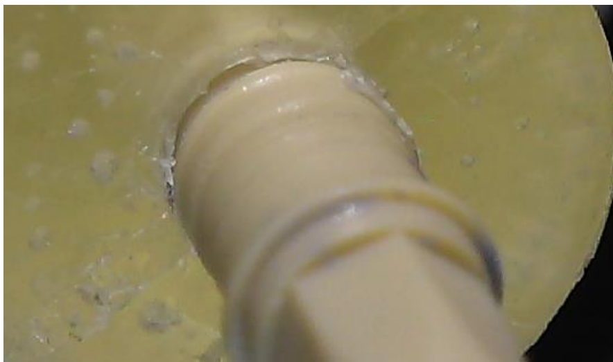
Obrázek 41 - Porušení vazby mezi implantátem a pryskyřicí po průběhu statické mechanické zkoušky implantátu.
