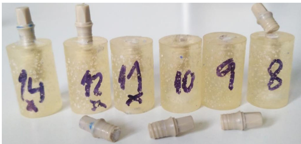
Obrázek 36 - Vzorky po dynamické únavové zkoušce
