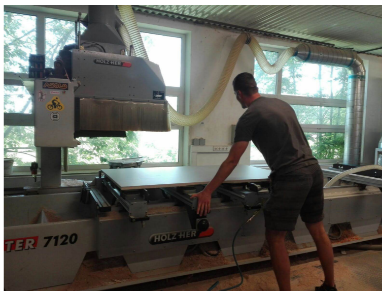
Příprava desky na frézování hlavního stolu.
