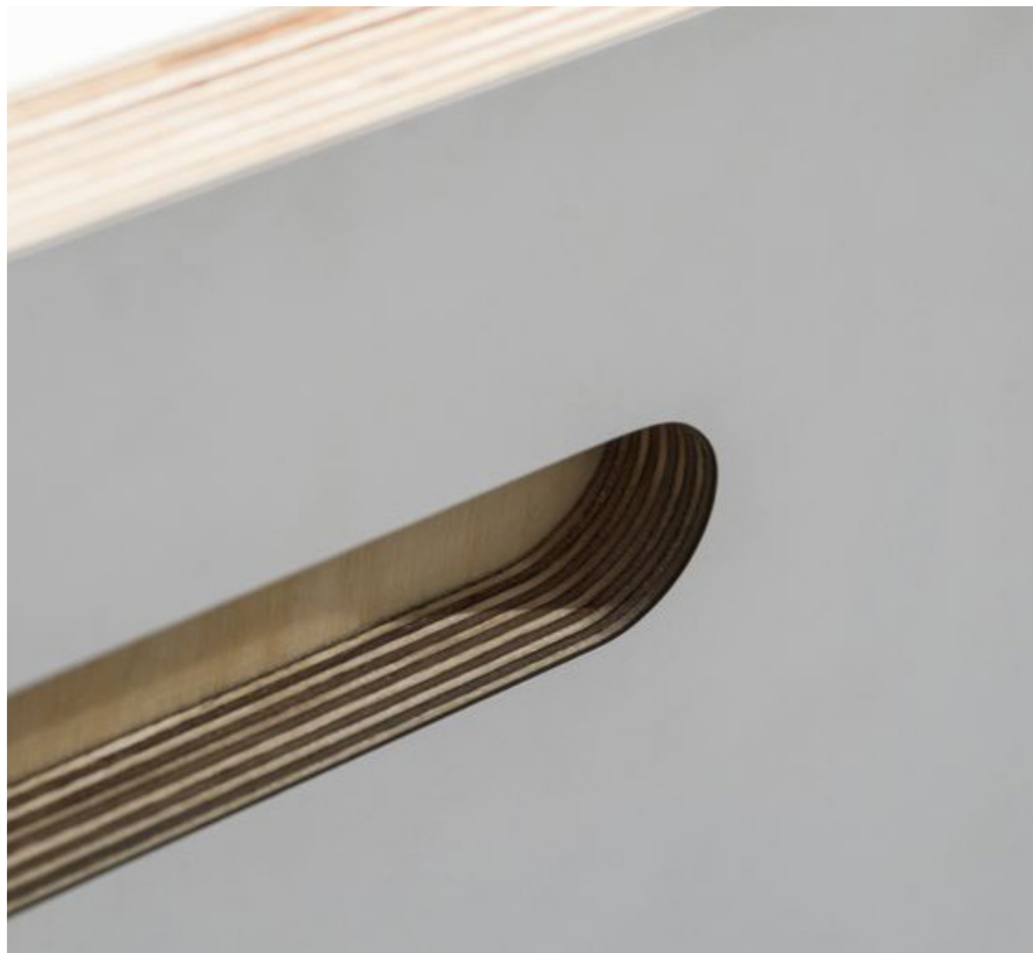
Příklad frézování do Multiplexu, na který je nalepen HPL laminát. Hrana je po frézování následně ručně zbrúšena zalakována, aby se zamezilo ulpívání špíny a nečistot. [14]
