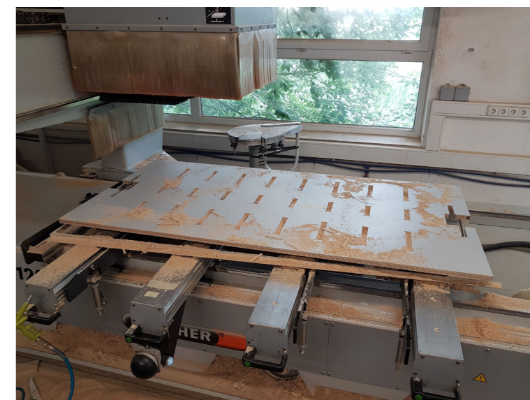
Pohled na hlavní desku okamžitě po frézování. Následovalo ruční frézování, broušení a lakování všech hran vodouředitelným lakem.
