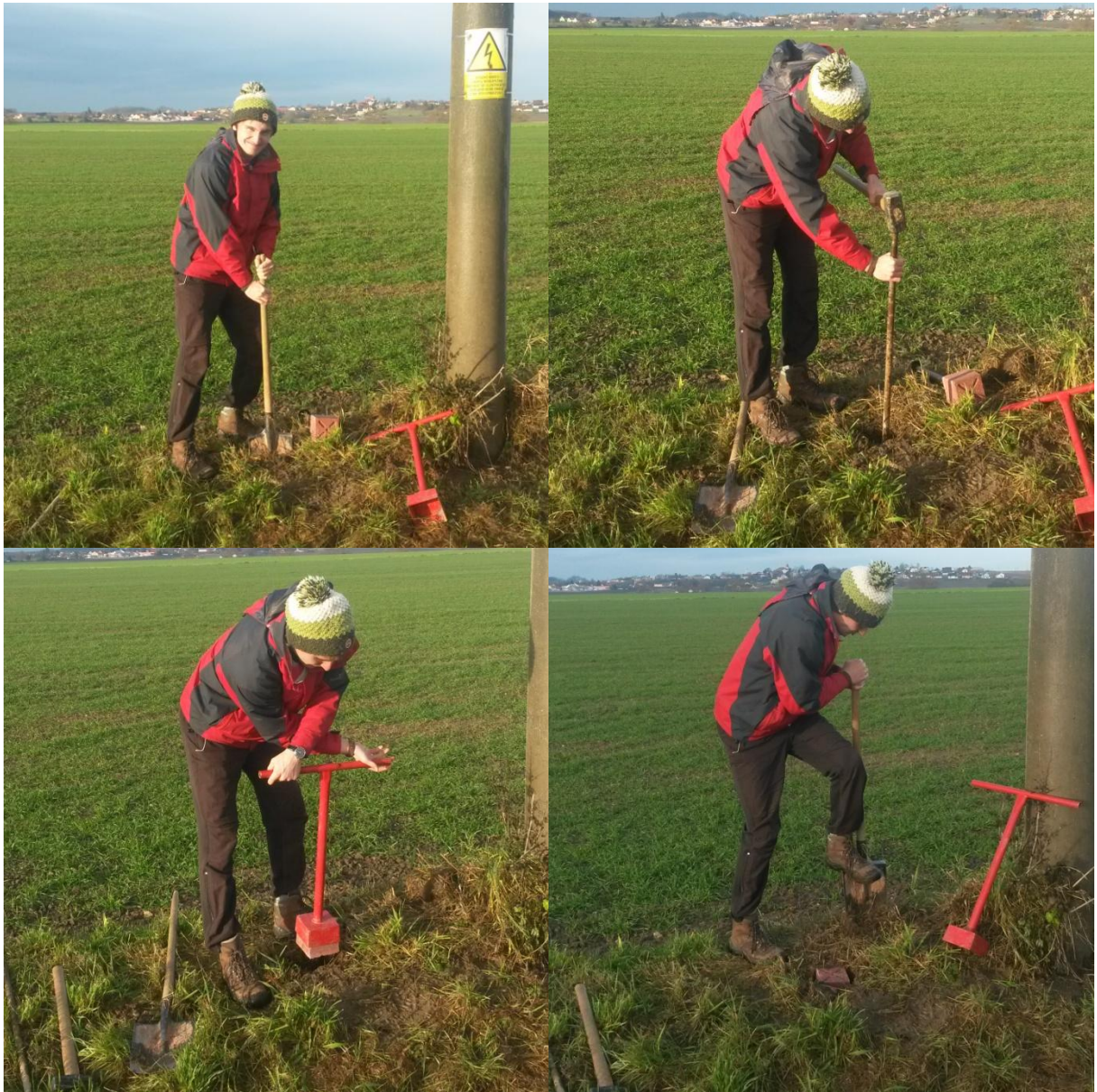
Obr. 5.2 Stabilizace bodu 541 závrtným znakem
