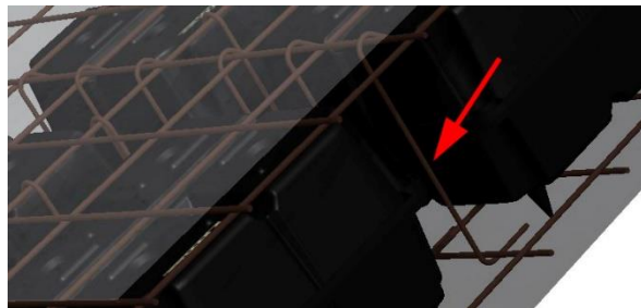
Obr. 5.34: Vizualizace zadávání smykové výztuže v softwaru firmy Daliform [zdroj: uboot-software.daliform.com]
