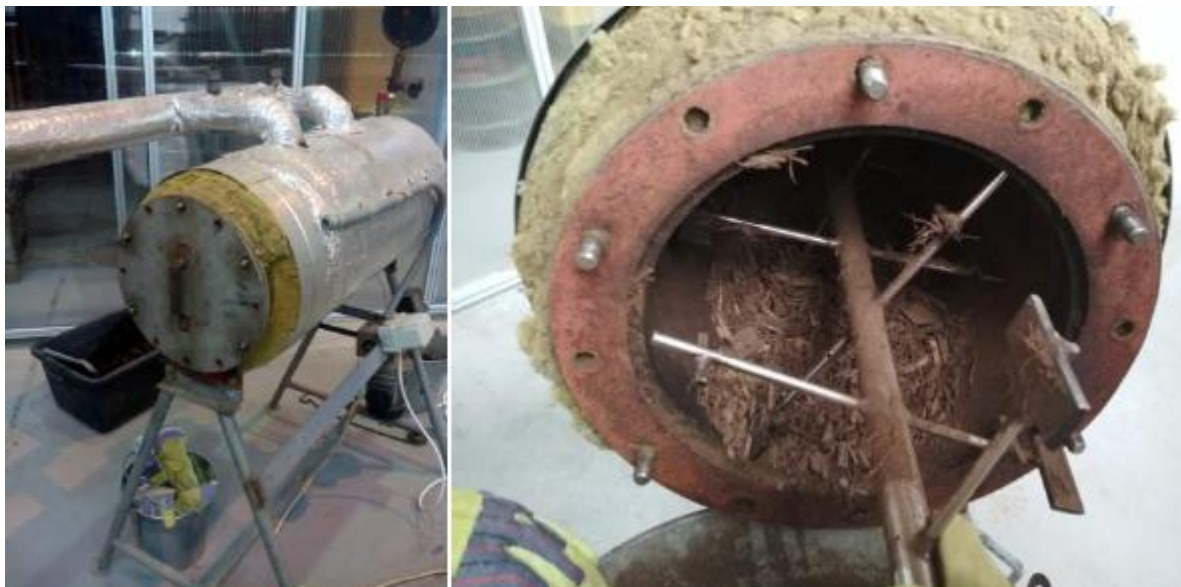
Obrázek 5.5 Vnitřní prostor kampaňové sušky s míchacím zařízením a sušeným materiálem
