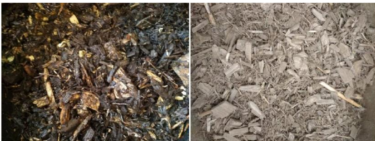
Obrázek 5.6 Porovnání dřevní štěpky před a po sušení
