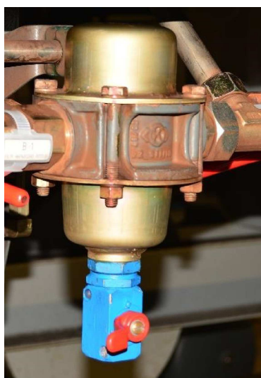
Obrázek 9: Odstředivý vzduchový filtr (v pohledu a v řezu) [1]
