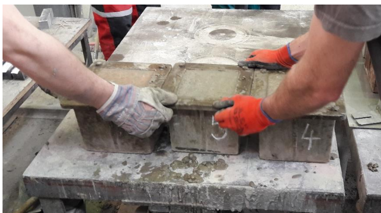
Obr. 20: Hutnění jedné skupiny krychlí na vibračním stole
