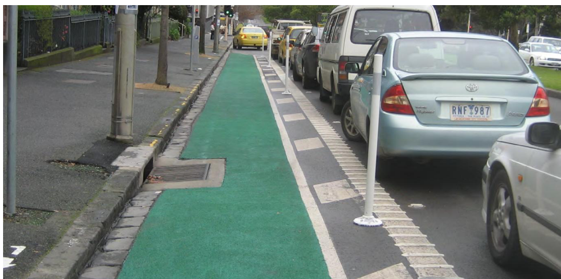
Obrázek 20 – Albert Street, Melbourne, Austrálie – fyzické oddělení jízdnic pruhů pro cyklisty od podélného parkování (zdroj: http://media.bv.com.au ) [17]
