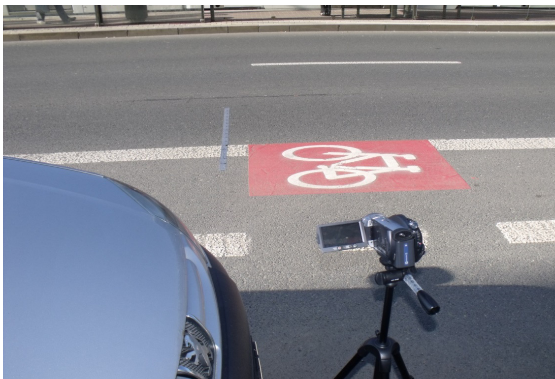
Obrázek 68 – Měření průjezdné vzdálenosti motorových vozidel (zdroj: Ing. Jiří Drbohlav)
