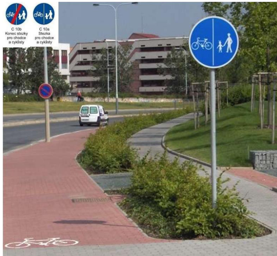
Obrázek 15 – Stezka pro chodce a cyklisty s odděleným provozem, zdroj: archiv Komise rady hlavního města Prahy pro cyklistickou dopravu ( http://cyklo.praha-mesto.cz ) [11]
