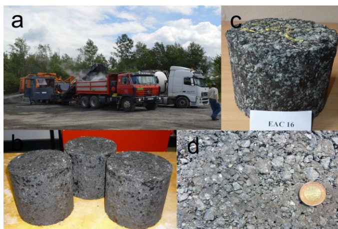
Obrázek 90: a) výrobní zařízení Wirtgen KMA-200 / nežádoucí přehřátí kameniva - odpařování vody ze směsi b) emulzní asfaltová směs - výroba v laboratoři c) emulzní asfaltová směs - in plant d) emulzní asfaltová směs - pokládka in situ
