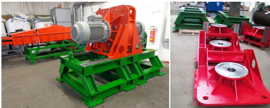
Obrázek 4: Vysokorychlostní impaktivní mlýn použitý v rámci dále popsaných experimentů
