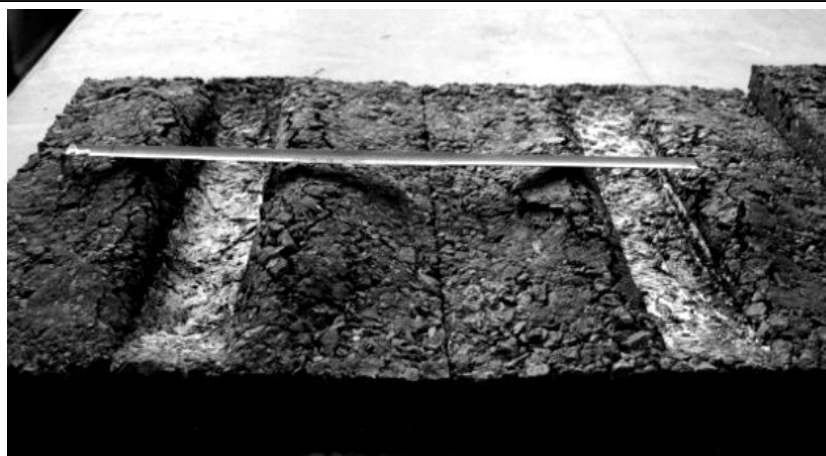
Obrázek 84: Hloubka vyjeté koleje na malém zkušebním zařízení
