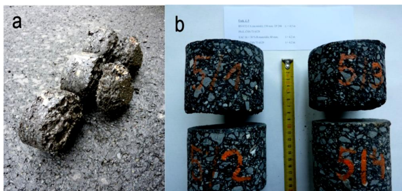
Obrázek 92: Ukázky jádrových vývrťů a) úsek č. 1 b) úsek č. 5
