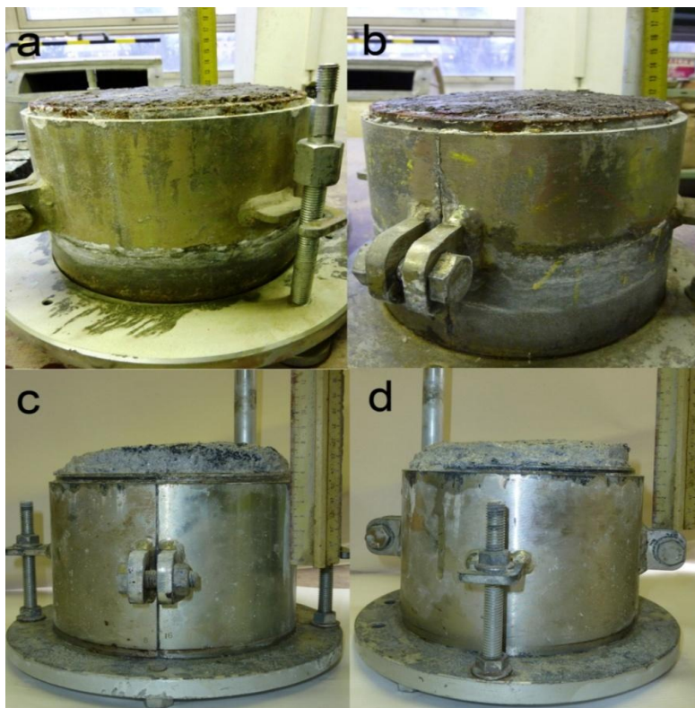
Obrázek 69: Zkušební vzorky po zkoušce bobtnání (145 dní) - a) recyklace za studena 10 %-hm. FPP Ledvice b) recyklace za studena 10 %-hm. FPP Tisová c) popílkový stabilizát FPP Ledvice d) popílkový stabilizát FPP Tisová
