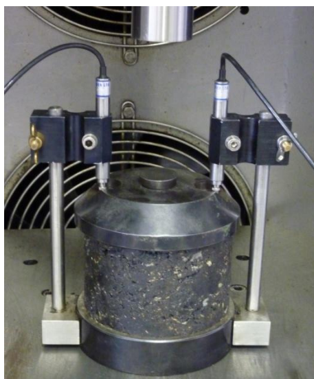
Obrázek 106: Zkušební sestava - cyklická zkouška v tlaku
