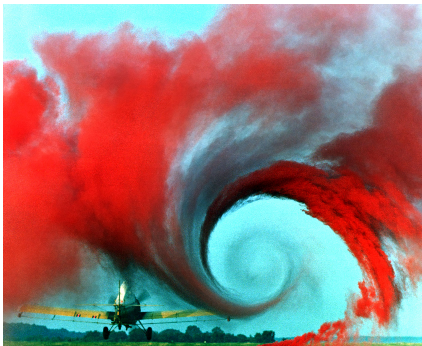
Obrázek 28: Turbulence v úplavu za letounem (Výzkumné centrum NASA, Langley. [12]
