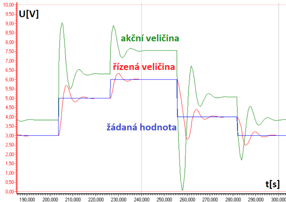
Graf 5 - ukázka řízení Wattova roztěžníku regulátorem dle J. Berner
